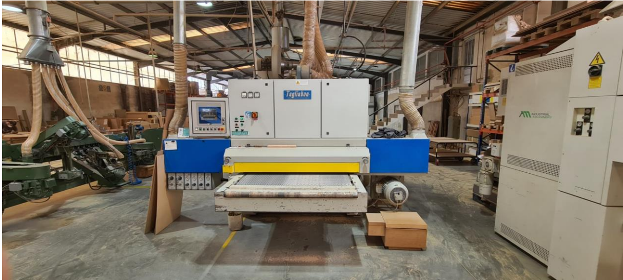
Figura 15 - "Máquina de Lixar Faces"
