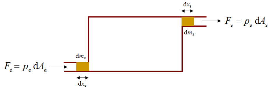
Figura 5.3. Esquema para apoio da definição de trabalho interno, devido ao escoamento do fluido.
