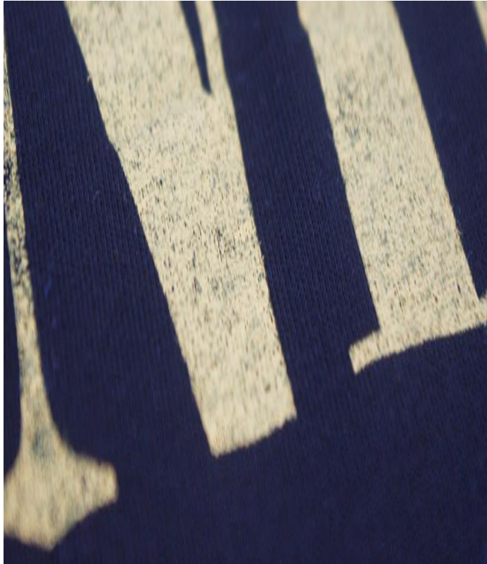
Figura 2 - Estampado corrosão, foto gentilmente da estamperia Ocre e Verde
