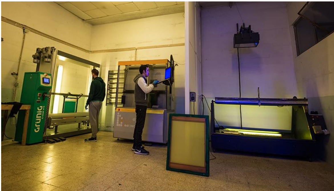
Figura 11 - Equipamento gravura: Máquina Grunig de aplicação das emulsões, projector de luz com lâmpada superior a 5.000 watts – foto gentilmente da Estamparia Fusão Print.
