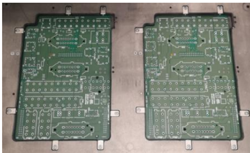
Figura 109 - Paleta de soldadura com molas de fixação
