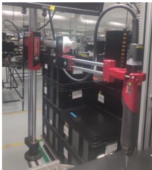
Figura 48 - Imagem do sistema de eixos para aparafusamento
