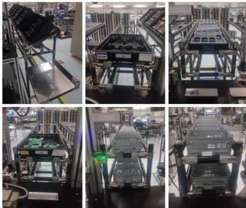
Figura 41 - Exemplo de rampas de abastecimento à linha de montagem final do produto "A"
