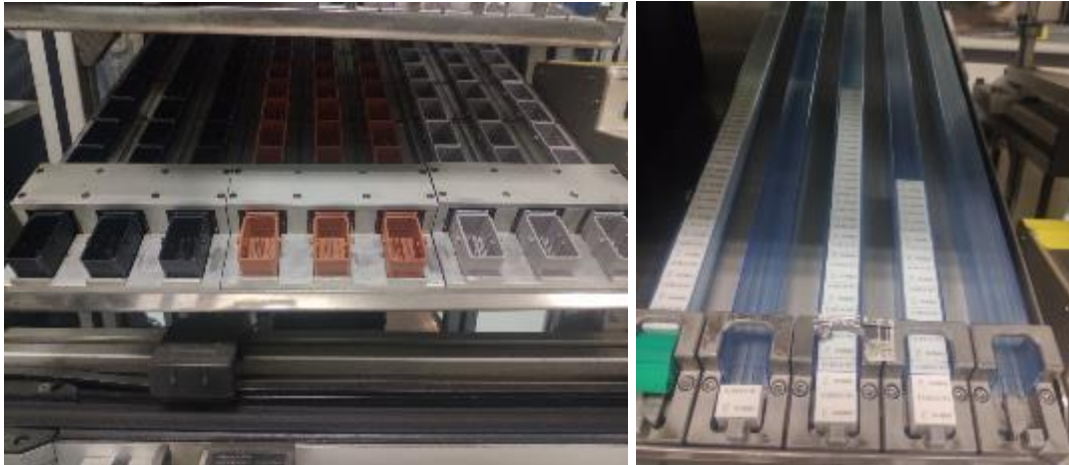
Figura 89 - Dispositivos para abastecimento para o produto "D" em CBA
