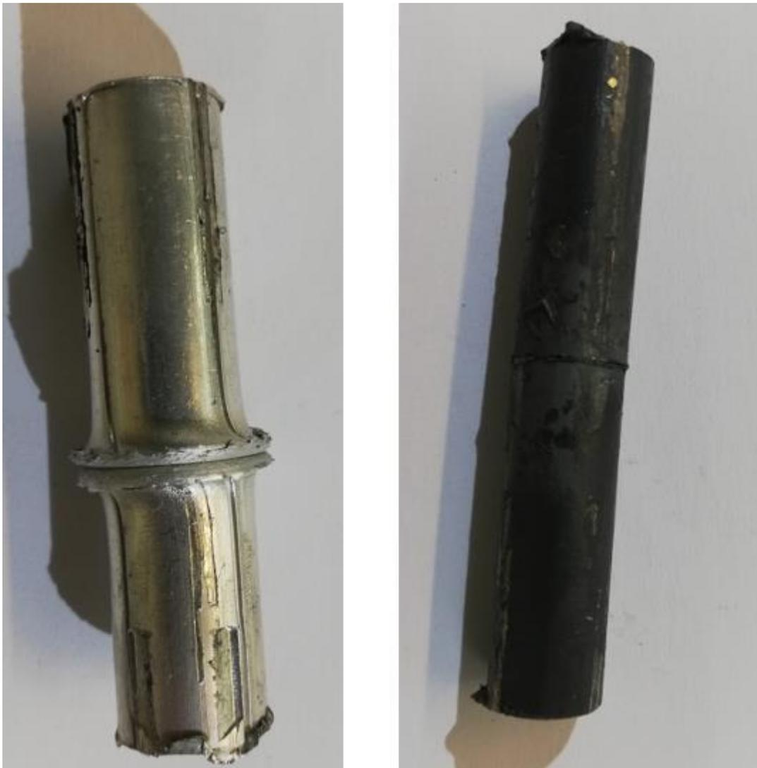
*Figura 34 – Provetes de Alumínio (imagem da direita) e Aço (à esquerda), produzidos usando componentes com 50 mm de comprimento.*
