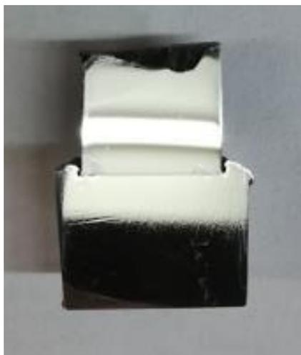
*Figura 38 – Aspeto final do provete, após realizadas as etapas de polimento no laboratório de Metalurgia.*
