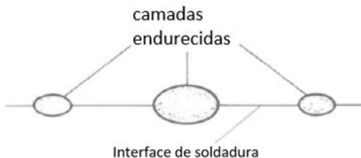
Figura 7 – Estrutura da interface na soldadura por pressão. Adaptado de [6].
