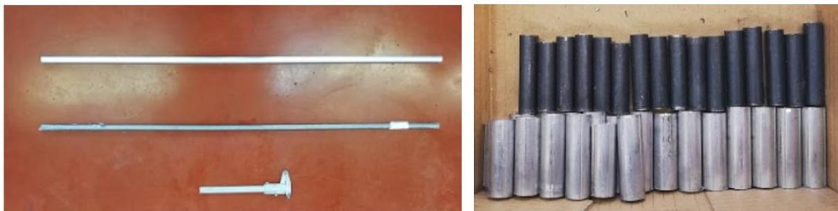
*Figura 29 – Componentes de aço e alumínio. Na imagem à esquerda, os varões no seu comprimento original, antes de qualquer corte. À direita, com um comprimento final de 50 mm.*
