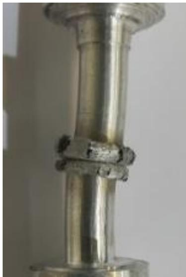
*Figura 44 – Encurvamento obtido num componente de alumínio, derivado da falta de coaxialidade quando aliada a uma carga axial elevada.*
