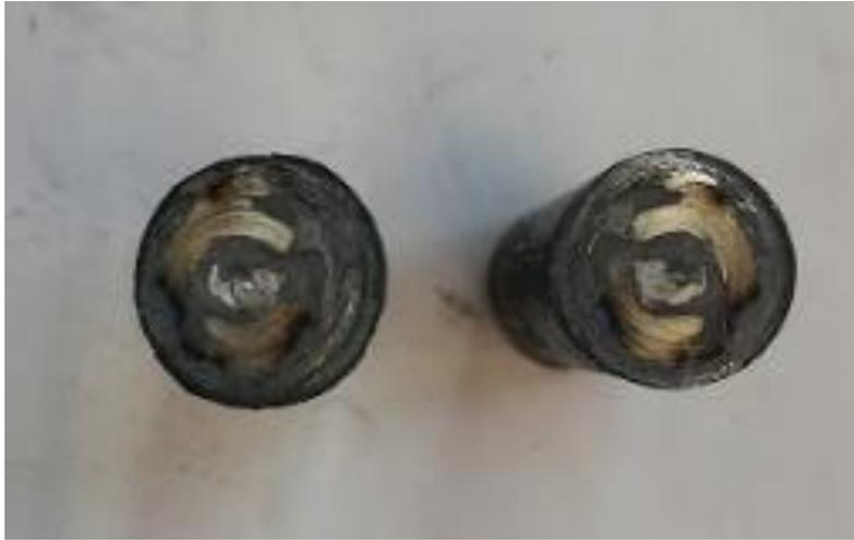
*Figura 33 – Interface do provete de aço, após ter sido submetido ao ensaio de dobragem. Evidencia uma clara falta de ligação em grande parte da sua área.*
