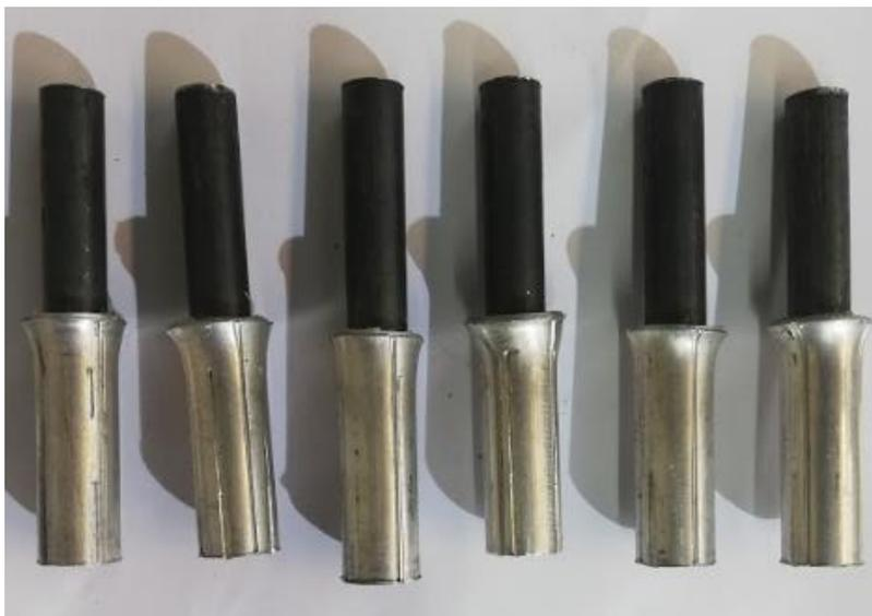
*Figura 36 – Provetes resultantes do estudo exploratório entre materiais dissimilares Aço/Alumínio.*
