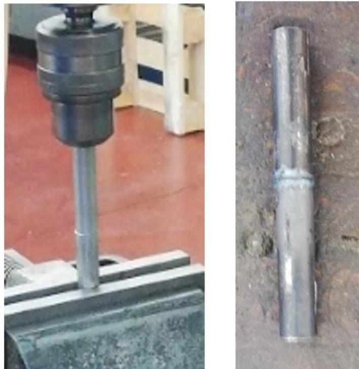
*Figura 31 – Primeiro ensaio de soldadura por fricção, realizado usando dois componentes de alumínio com 100 mm de comprimento e  $\varnothing 15,6$  mm.*
