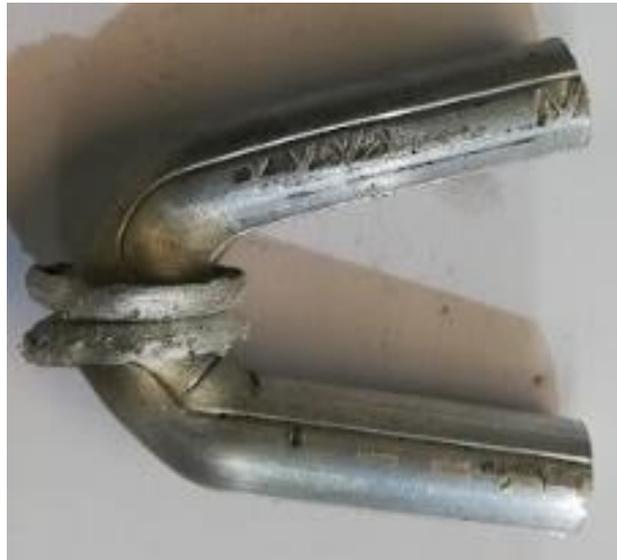
*Figura 27 – Provede de Alumínio submetido ao ensaio de dobragem. Sublinhe-se que este não foi obtido em concordância com a norma supracitada.*
