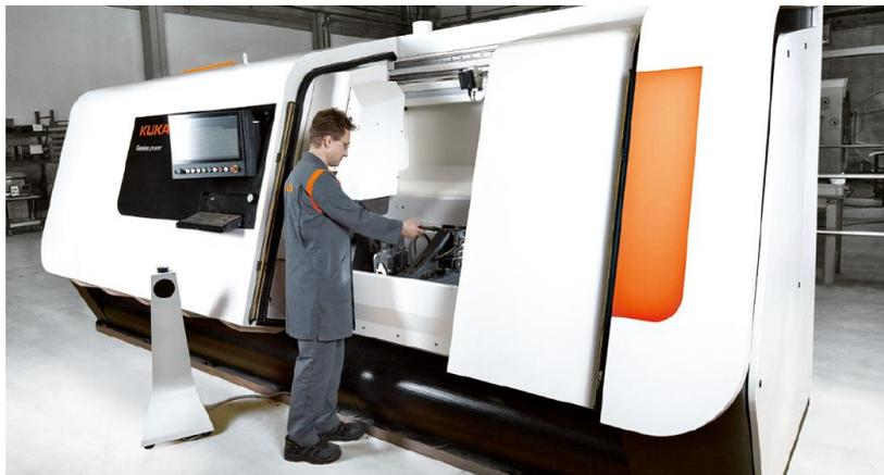
*Figura 45 – Dispositivo da empresa KUKA capaz de exercer uma força de forjagem de 450kN e soldar secções máximas de 3750mm<sup>2</sup>. Adaptado de [23].*
