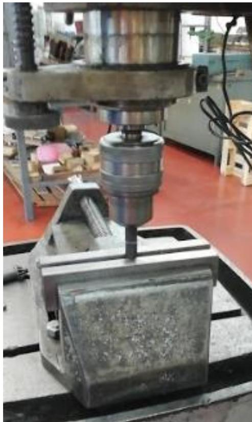
*Figura 30 – Primeira fase do processo de soldadura por fricção – Fase de fricção.*
