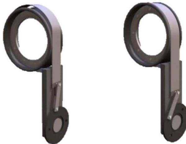
*Figura 50 - Sistema de travagem. Na imagem à esquerda a correia permite a rotação do rolamento, estando, portanto, o sistema destravado. Na imagem da direita, a correia exerce uma pressão numa grande área de rotação da chumaceira, impedindo a sua rotação. Adaptado de [28].*
