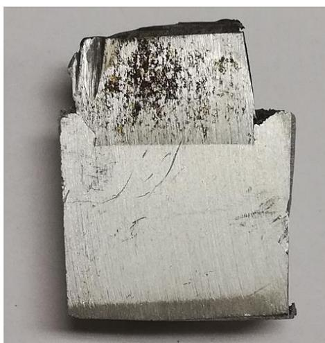
*Figura 37 – Corte longitudinal em provete obtido usando a soldadura de materiais dissimilares Aço (material da porção superior do provete) e Alumínio (material da porção inferior do provete).*
