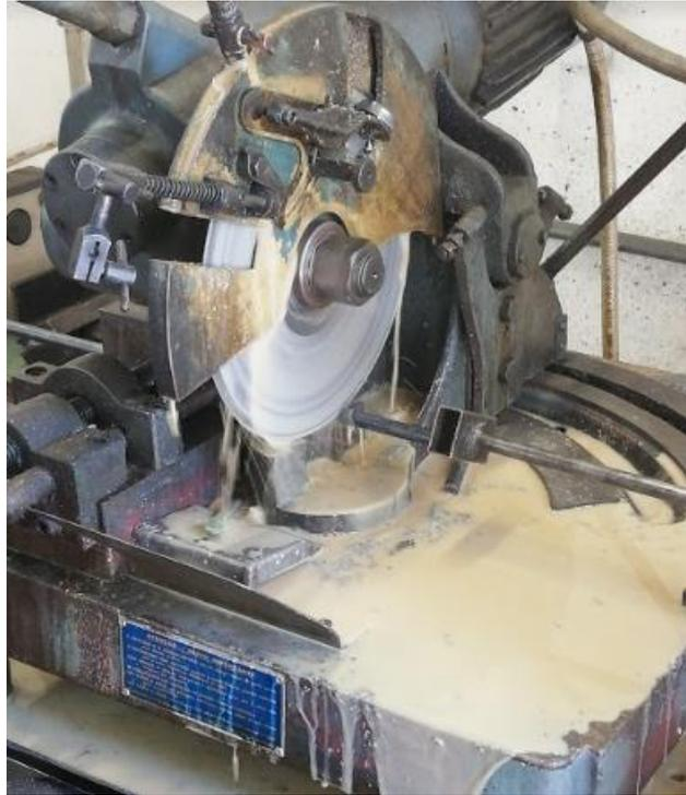
*Figura 28 – Corte dos componentes em aço, com o auxílio da serra de disco.*
