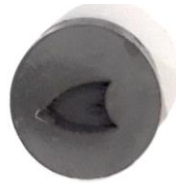
Figura 78: Exemplo de uma amostra com a geometria maquinada a laser
