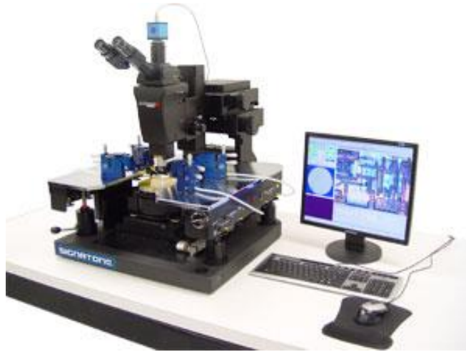
Figura 59: Equipamento de medição da resistividade elétrica a quatro pontos
