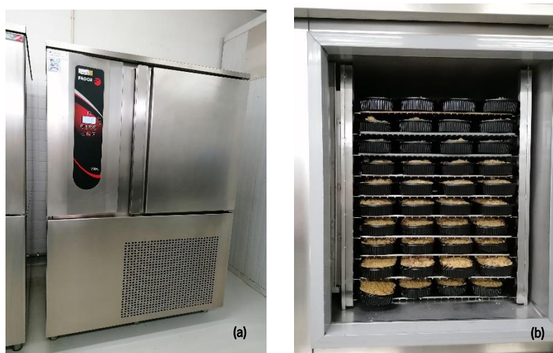
Figura 19 - (a) Abatedor de Temperatura 2 da Cantina de Santa Tecla (b) Processo de Arrefecimento de "Arroz de Pato" nas embalagens individuais.
