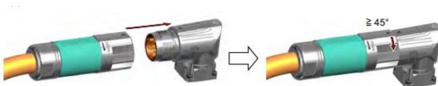
Figura 77 - Processo de conexão do motor ao cabo Motion-Connect. 57
