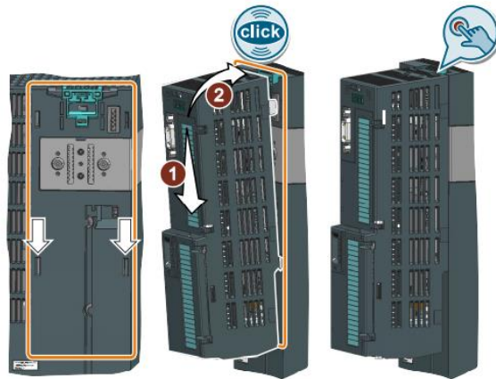
Figura 73 - Processo de montagem da unidade de controlo na fonte de alimentação de corrente.
