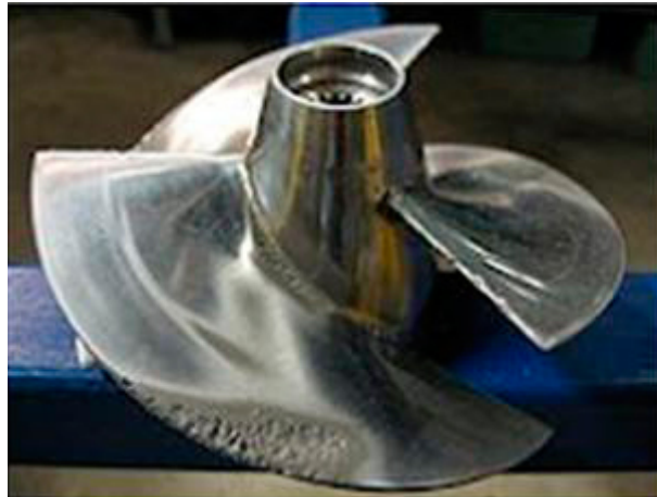
Figura 12 Hélice danificada por cavitação, retirada de («O que é a cavitação?», 2013)
