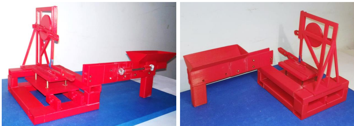
Figura 28 – Protótipo, impresso em PLA, do equipamento completo.
