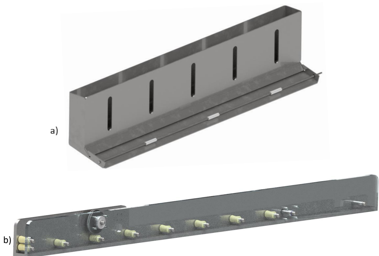
Figura 49 – Representação do sistema de alimentação projetado, a) o sistema de armazenamento e doseamento de varões de madeira, b) o sistema de fornecimento controlado de varões de madeira, onde se colocou uma das laterais transparente para permitir visualizar o interior.
