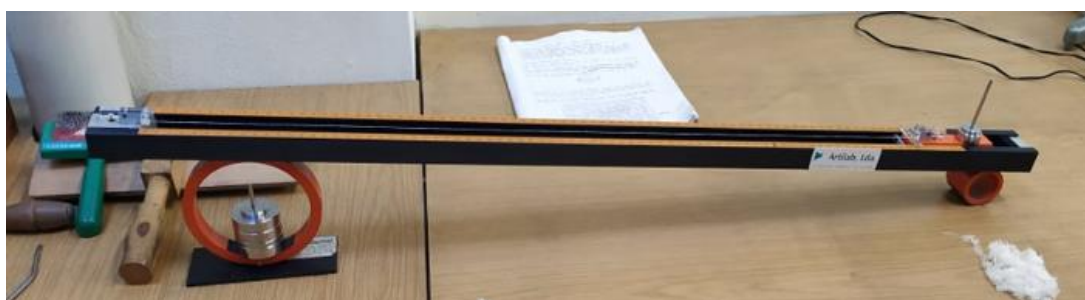
Figura 14: Aparelho usado no ensaio da determinação da massa linear de um fio retirado de um tecido, Crimpster
