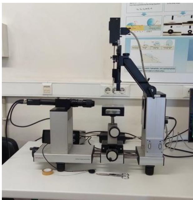
Figura 20: Goniómetro Contact Angle System OCA utilizado no ensaio para a determinação do ângulo de contacto
