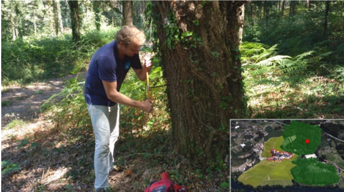
Figura 181 – Procedimento de recolha de amostras na mata da “Tapada” com recurso a broca manual.
