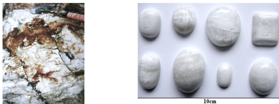
Figura 4: Petalite (ocorrência natural típica) das Minas do Rebentão em Vila Nova de Paiva e produtos de ensaio em “cabochon” - fácil polimento e boa aquisição do efeito “olho de gato”.
