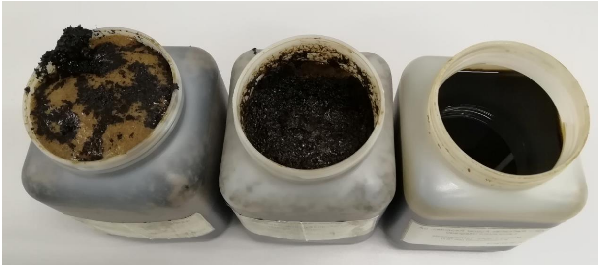
Figura 28 - Amostras de melão não tratado (esquerda), centrifugado (centro) e tratado e centrifugado (direita), após cerca de 4 meses de armazenamento.
