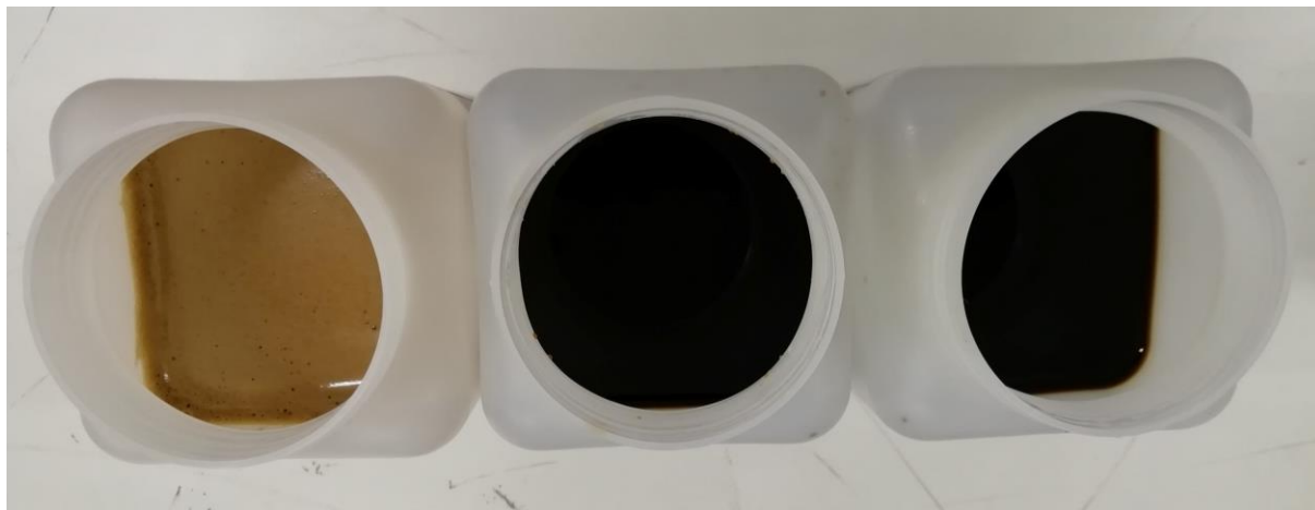
Figura 26 - Amostras de melão não tratado (esquerda), centrifugado (centro) e tratado e centrifugado (direita) no dia 1.
