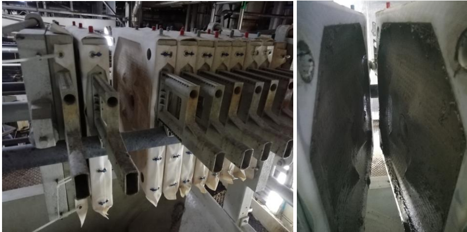
Figura 24 - Verificação da formação de bolo durante teste experimental com o filtro.
