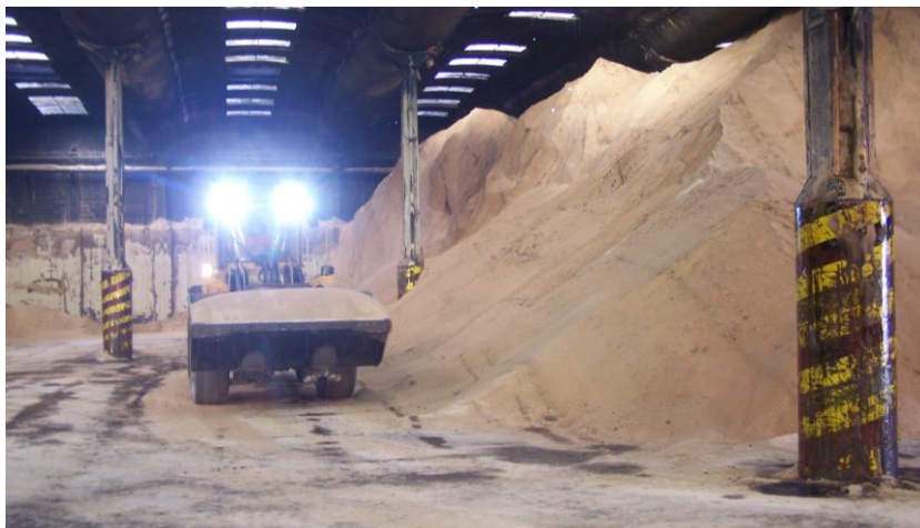
Figura 17 - Pá mecânica realizando operações de transporte de rama no armazém.
