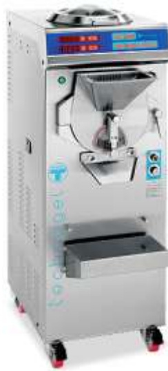
Figura 6 - Máquina Technogel Mixgel 30, utilizada na produção dos gelados.
