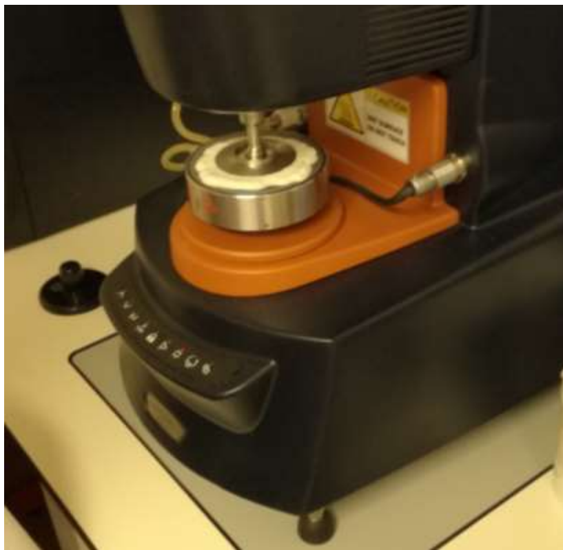
Figura 10 - Reómetro utilizado nos testes reológicos com uma amostra do gelado produzido.
