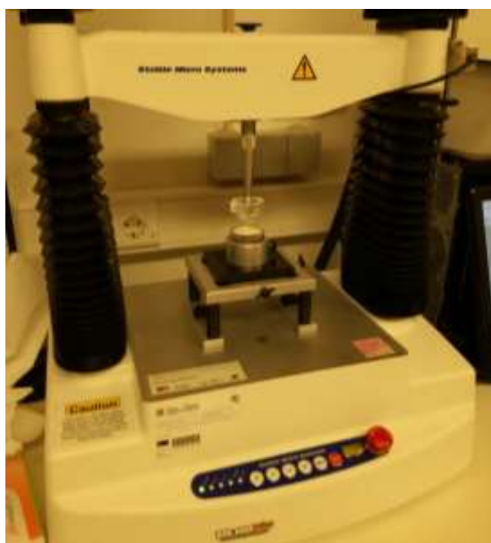
Figura 11 - Texturómetro TA.HD Plus, utilizado na análise da dureza, com amostra de gelado desenvolvido.
