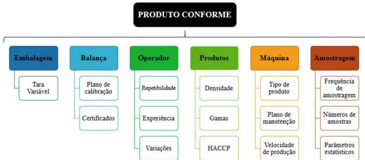
Figura 5. Controlos na produção para obtenção de um produto conforme (adaptado de Ribeiro, n.d.).
