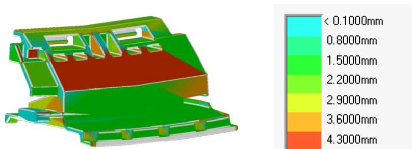
**Figura 41.** Resultado da análise de espessuras da peça SealClip.
