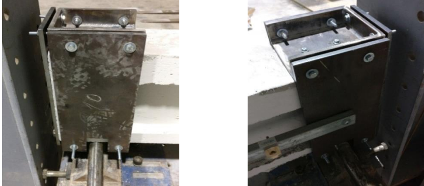
Figura 6. Chapas metálicas para o confinamento dos apoios
