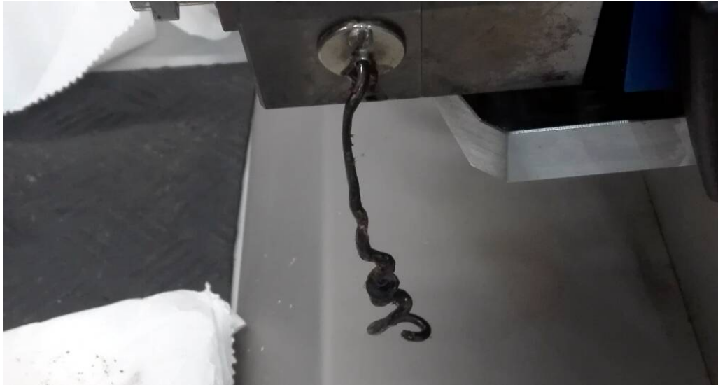
Figura 86: Extrusão do kraft com cardanóis na fieira de 3 mm.
