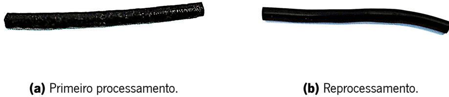
Figura 40: Impacto do reprocessamento nos filamentos de lenhina com ABS.
