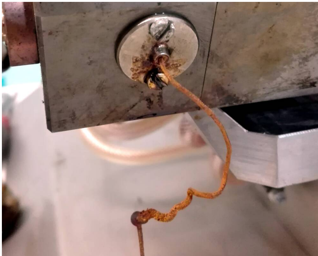
Figura 85: Extrusão da LS:CBLK na proporção 75:25.
