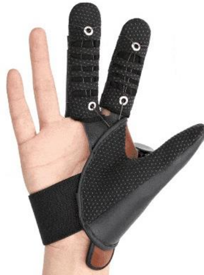
Figura 13 - Fios de nitinol colocados na luva [16]
