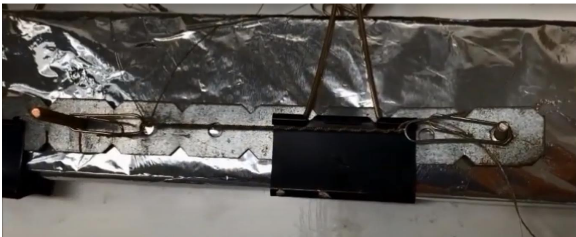
Figura 62 - Colocação do enrolamento sob tensão [35]
