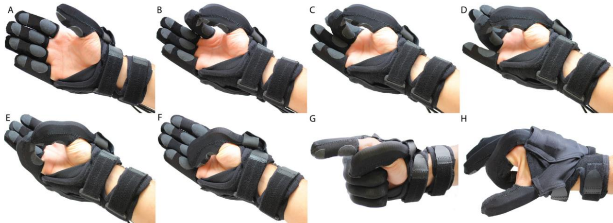
Figura 6 - Diferentes modos de atuação da luva: A) Nenhum dedo dobrado; B) Polegar e indicador dobrados; C) Polegar e médio dobrados; D) Polegar e anelar dobrados; E) Polegar e mínimo dobrados; F) Apenas polegar dobrado. G) Sinal de apontar – todos os dedos sobrados exceto o indicados; H) Apenas o indicador dobrado [5]
