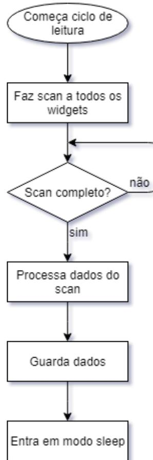
**Figura 3.14:** Diagrama de blocos da leitura e processamento dos sensores capacitivos
