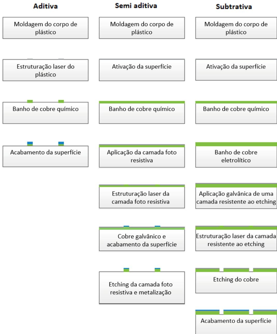
**Figura 2.5:** Processos de estruturação laser (Adaptado de [1])
