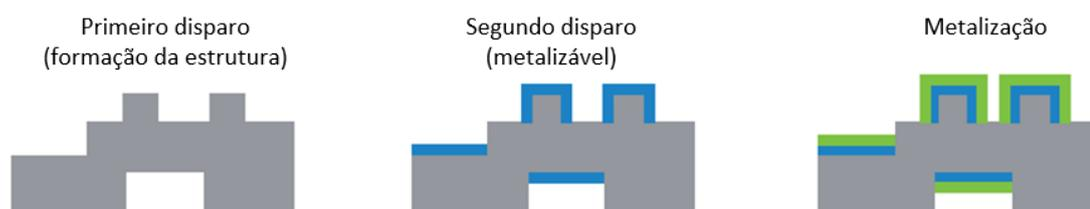
**Figura 2.9:** Processo de produção de um MID utilizando a técnica de injeção de disparo duplo (Adaptado de [1])
