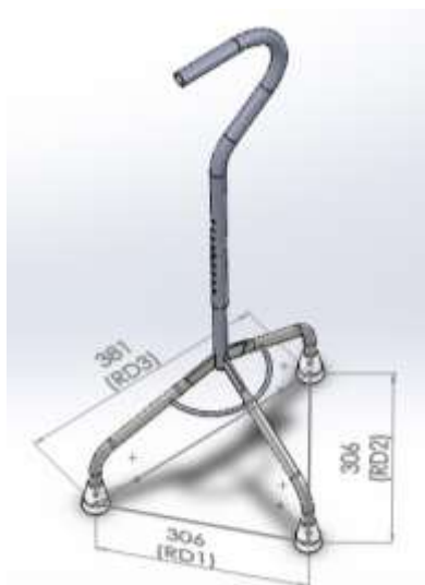
Figura 12: Bengala "Pirâmide" concebida no software SolidWorks®, RD1, RD2, RD3 são as distâncias entre as três ponteiros da bengala (OrthosXXI, 2017)
