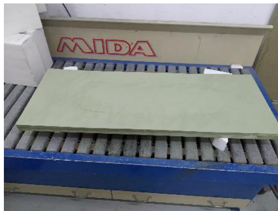
Figura 7* - Retificação da superfície para aplicação de primário.
