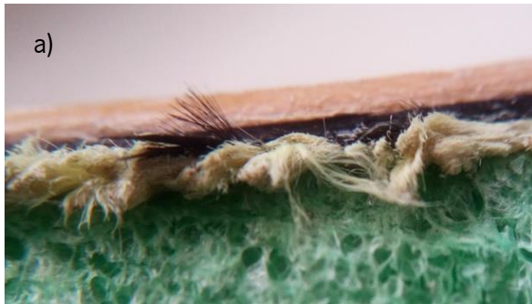
Figura 19 - a) Imagem ilustrativa dos defeitos existentes dentro das placas, onde é visível um local com fibras não impregnadas de um provete retirado da placa LongB_3. b) Inconformidades nos ensaios de flexão resultantes de um local com fibra não impregnada, o que resultou em locais com menor rigidez e por sua vez locais mais frágeis quando sujeitos a estas solicitações mecânicas.
