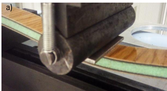
Figura 20 -a) A chapa usada aumenta a área de contacto entre o calcador (objeto escuro e cilíndrico na figura) e a amostra ao ser colocada entre os dois objetos; b) Ao retirar os apoios esféricos utilizados inicialmente, foi aumentada a área de contacto entre os novos apoios (objeto escuro na figura) e a amostra, permitindo realizar os ensaios de acordo com é estipulado na norma em uso.
