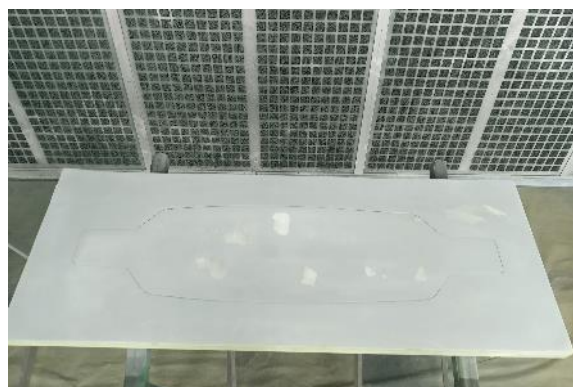
Figura 9* - Retificação da superfície com primário para aplicação da pintura final.
