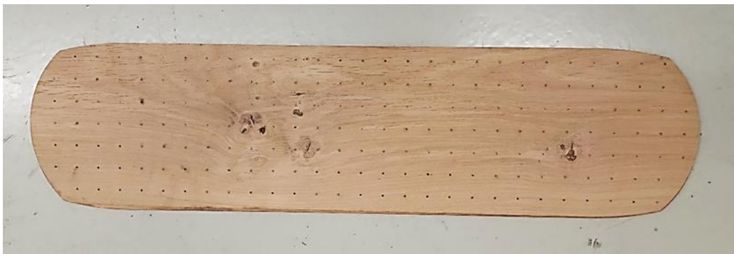
Figura 114 – Corte da lâmina de madeira no LASER para posterior colocação no laminado da prancha de skateboard.
