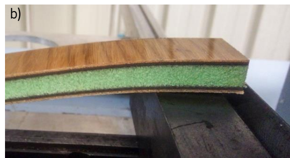
Figura 20 -a) A chapa usada aumenta a área de contacto entre o calcador (objeto escuro e cilíndrico na figura) e a amostra ao ser colocada entre os dois objetos; b) Ao retirar os apoios esféricos utilizados inicialmente, foi aumentada a área de contacto entre os novos apoios (objeto escuro na figura) e a amostra, permitindo realizar os ensaios de acordo com é estipulado na norma em uso.
