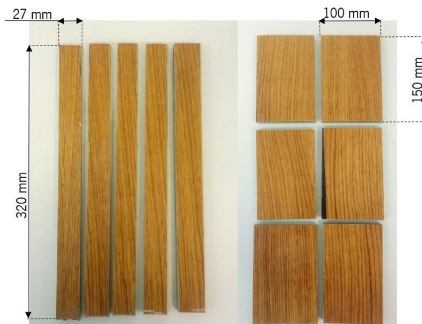
Figura 15 – Provetes com as dimensões normalizadas retirados das placas infundidas. À esquerda estão os provetes de ensaios de flexão e à direita os provetes para ensaios de impacto.
