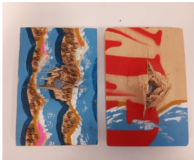
Figura 35 - Danos causados nos provetes de impacto pelo dardo durante os ensaios de impacto.
