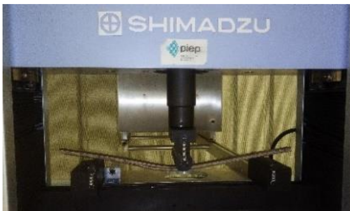
Figura 58 - Ensaio de flexão em 3 pontos (dois apoios e um calçador).
