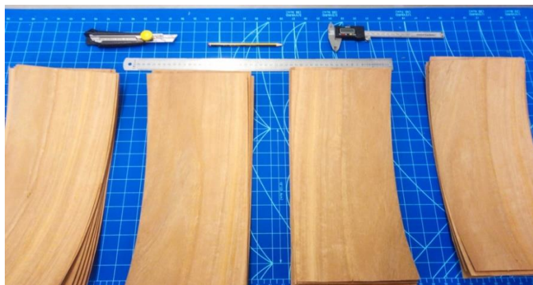
Figura 52 - Folheado de madeira de eucalipto, preparado para obter um núcleo consolidado deste tipo de madeira.
