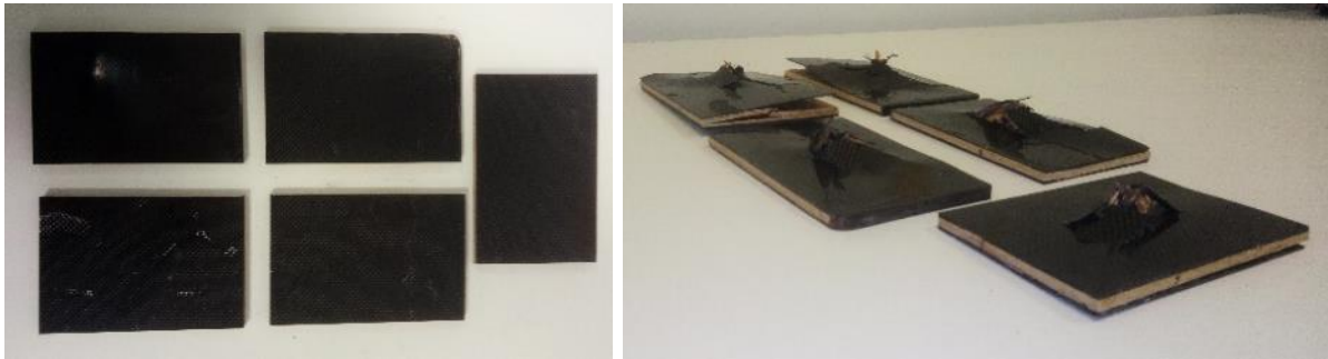
Figura 60 - a) Provetes de impacto; b) Provetes de impacto após realização dos ensaios ao impacto.
