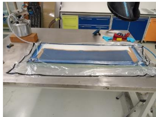
Figura 16* - Colocação do saco de vácuo.
