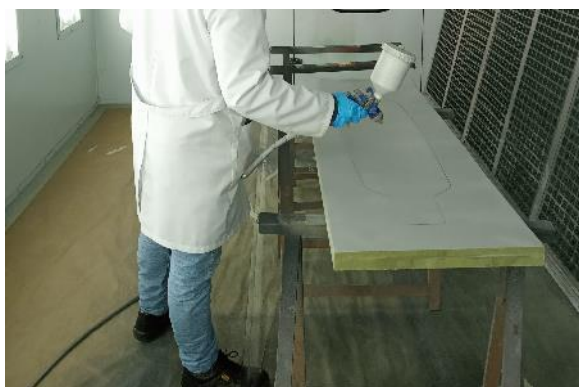
Figura 8* - Aplicação de primário.
