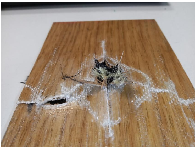
Figura 30 - Existência de fibras secas de carbono e aramida no interior do provete testado ao impacto.
