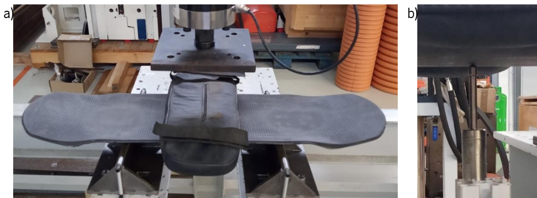
Figura 118 - Aparato para realização do ensaio ao protótipo final. a) visualização geral (apoios, calcador com saco de areia e prancha); b) LVDT capaz de medir mais apropriadamente o deslocamento linear provocado na prancha.
