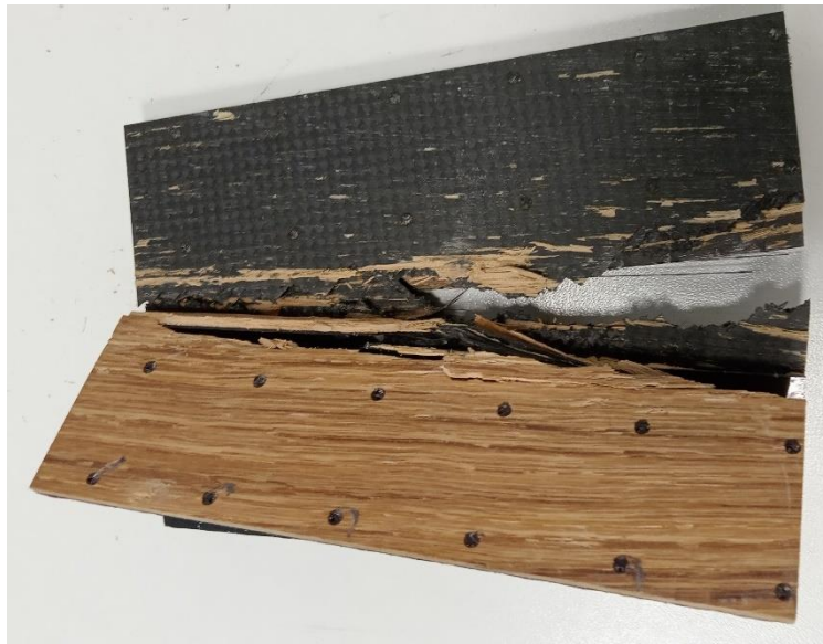
Figura 100 - Provete completamente danificado pelo dardo durante os ensaios de impacto à placa SkateB_4.
