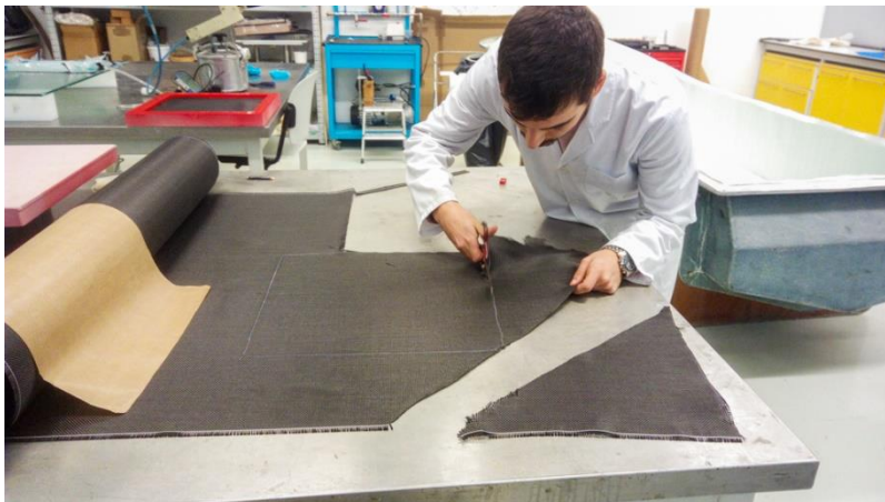
Figura 54 - Corte das fibras de carbono com as dimensões exatas, de modo a encaixar facilmente no molde e não comprometer o processamento.
