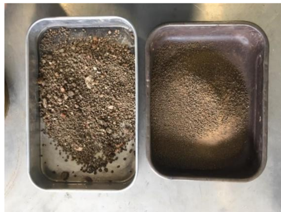
Figura 24: Solo retido e passado no peneiro 10 (2 mm)
