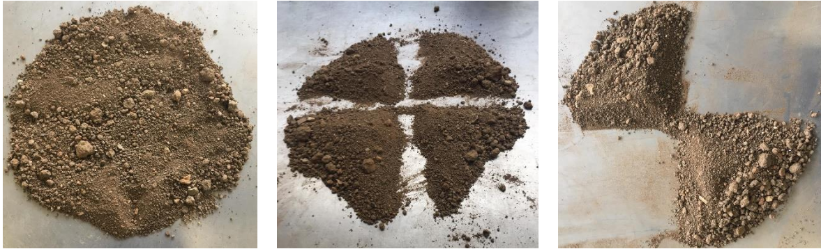
Figura 22: Esquartelamento do solo
