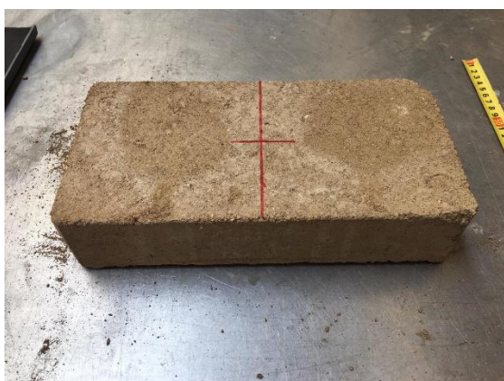
Figura 76: Ensaio de Erosão: Provede 1 face 3
