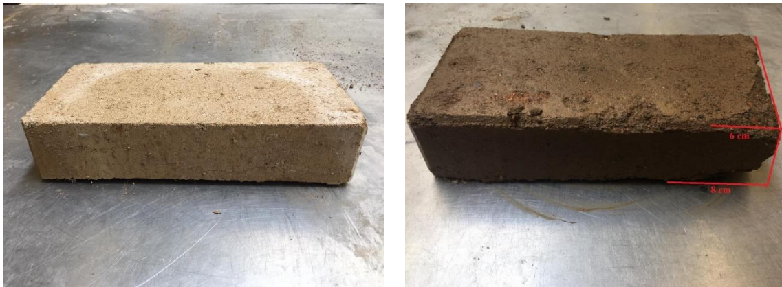
Figura 84: Ensaio de Erosão: Provete 3 face 3
