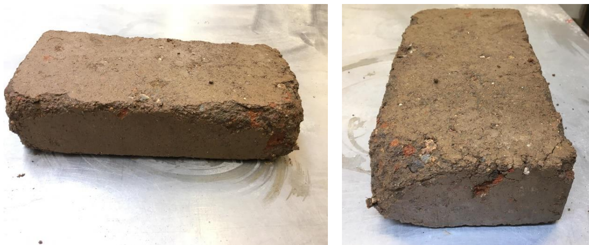
Figura 67: Restantes fotos do ensaio de absorção de água por imersão: provete 2
