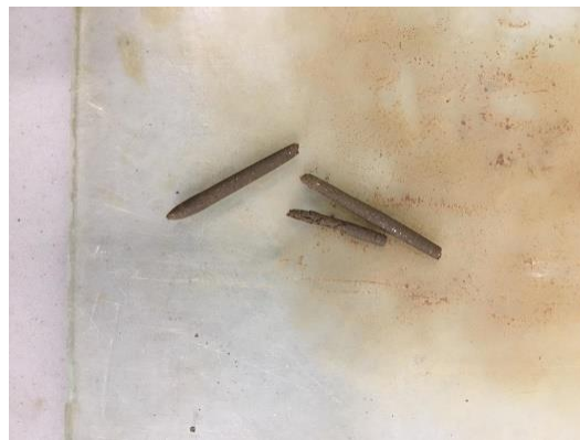
Figura 35: Rotura do filamento
