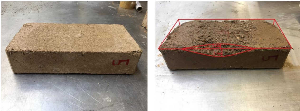
Figura 90: Ensaio de Erosão: Provete 5 face 1
