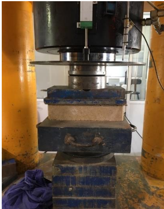
Figura 46: Pórtico do ensaio á compressão
