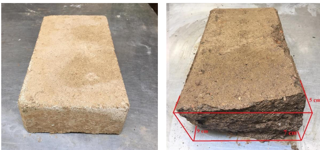
Figura 79: Ensaio de Erosão: Provete 2 face 2
