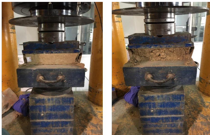
Figura 64: Ensaio à compressão: rotura do provete
