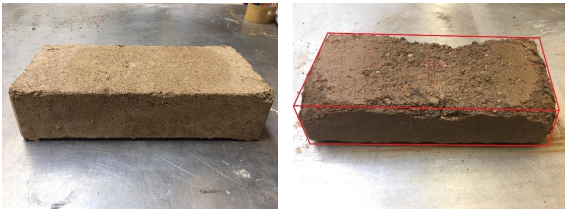
Figura 92: Ensaio de Erosão: Provete 5 face 3
