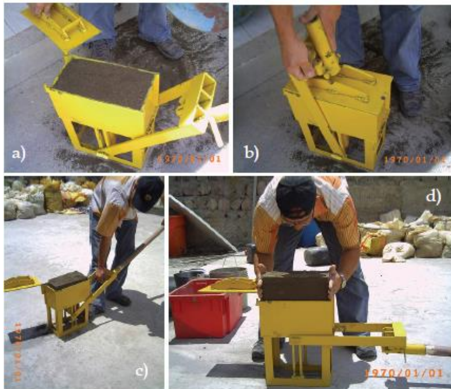
Figura 19: Execução de BTC com a prensa CINVA-Ram: a) Enchimento do molde com terra, b) Confinamento da mistura, c) Elevação do BTC, d) Retirada do BTC [11]
