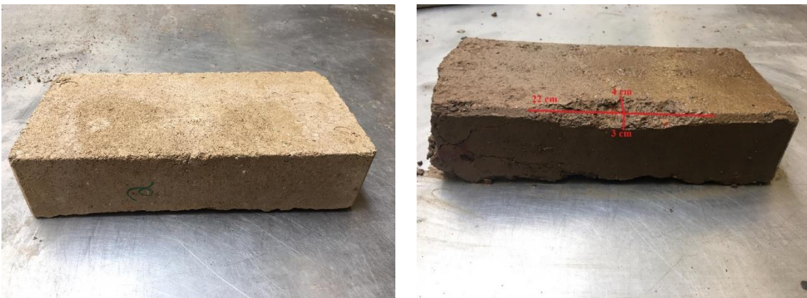
Figura 78: Ensaio de Erosão: Provete 2 face 1
