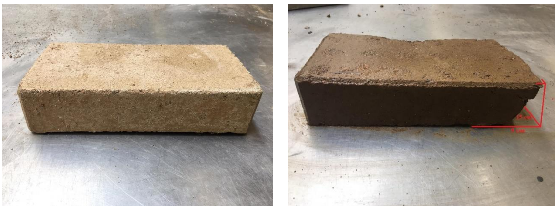
Figura 80: Ensaio de Erosão: Provete 2 face 3
