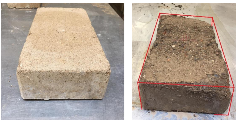
Figura 93: Ensaio de Erosão: Provete 5 face 4
