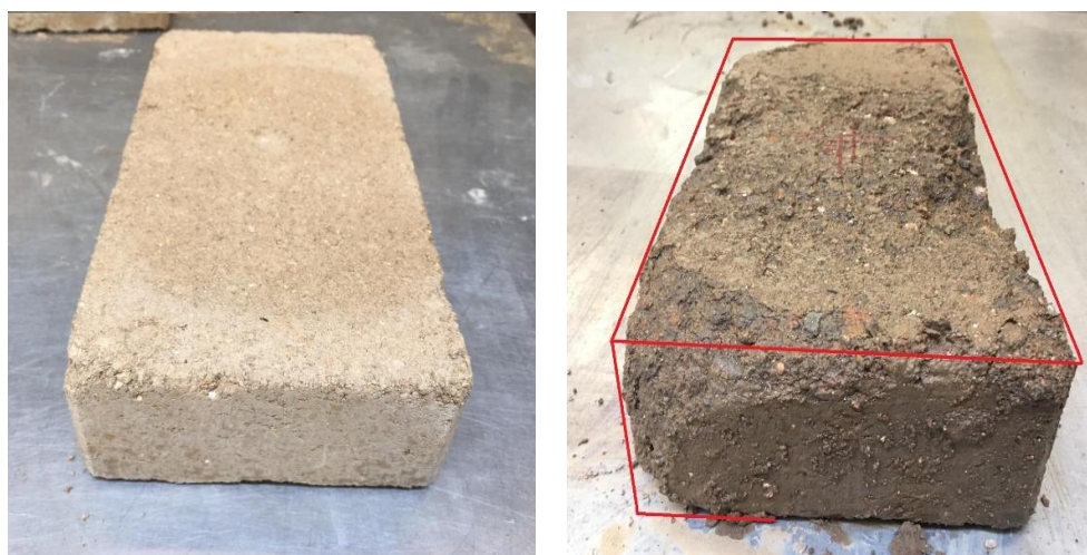
Figura 91: Ensaio de Erosão: Provete 5 face 2
