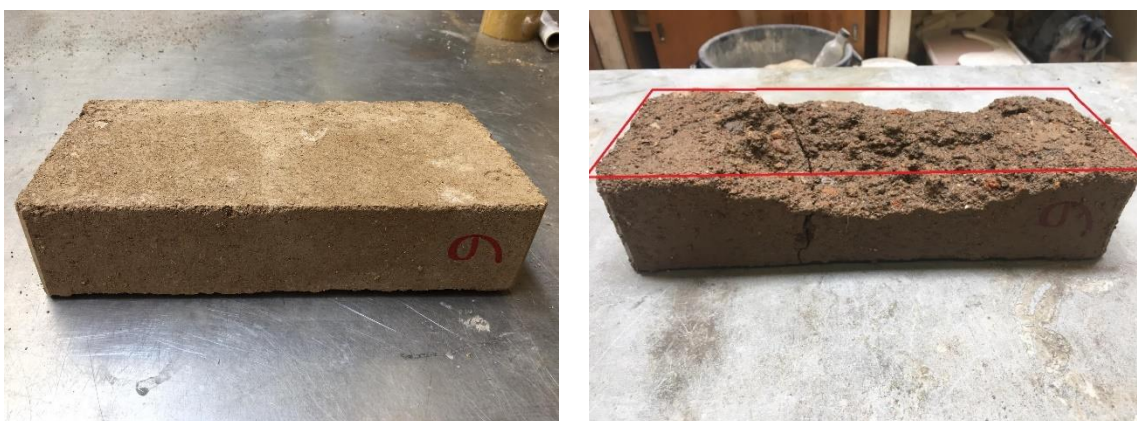
Figura 94: Ensaio de Erosão: Provete 6 face 1
