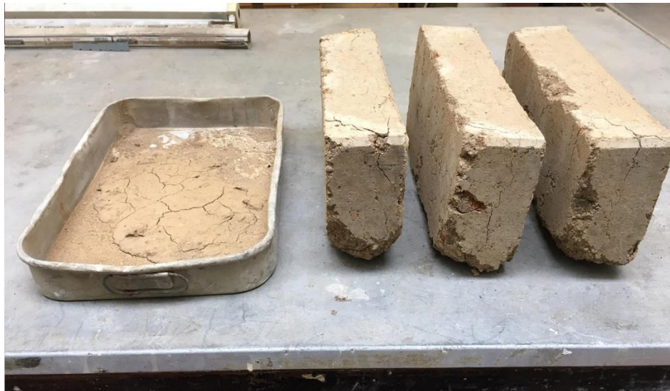
Figura 69: Provetes do ensaio de absorção de água por imersão e perda de massa
