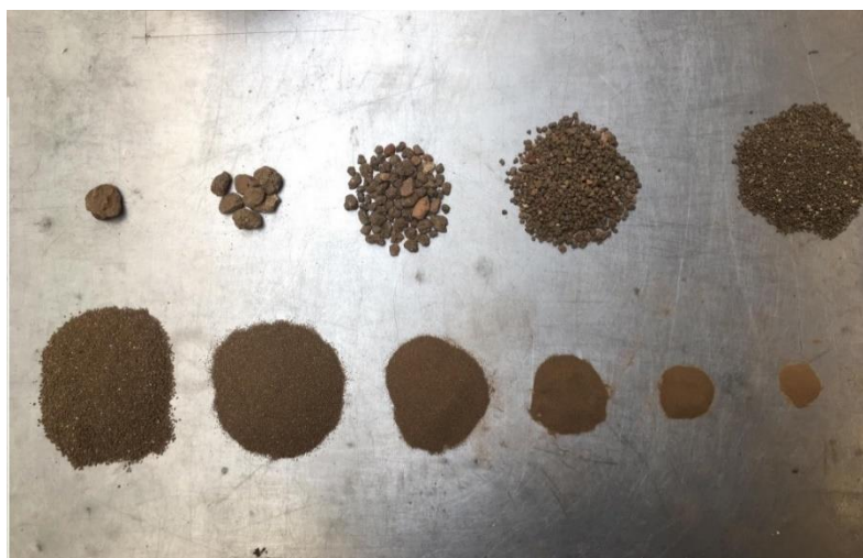
Figura 58: Foto do resultado do ensaio de análise granulométrica por via seca
