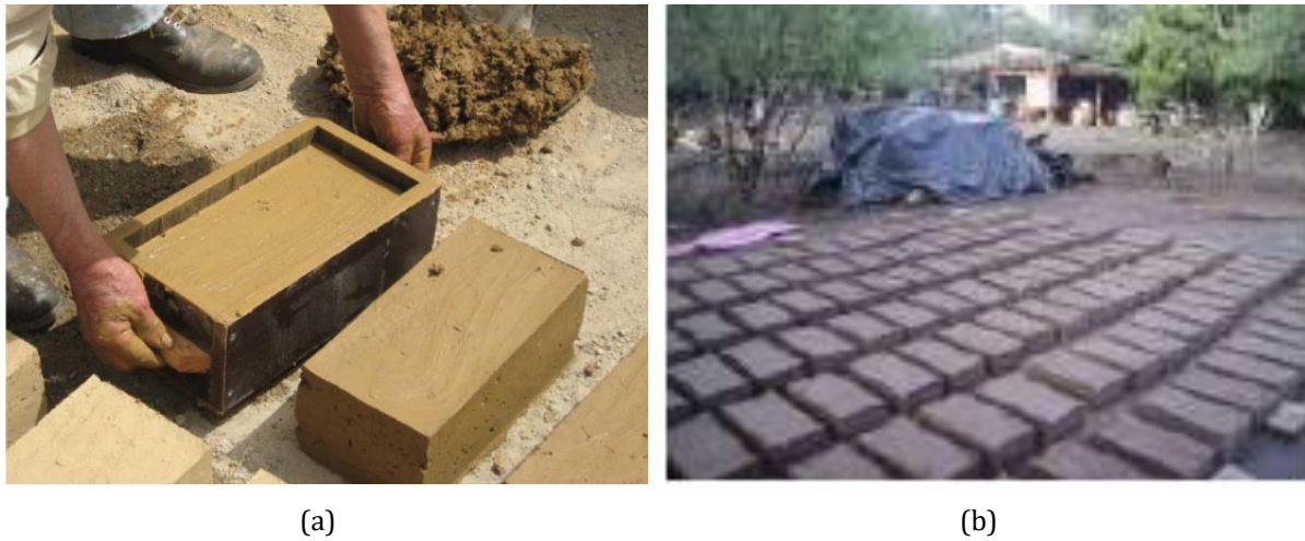
Figura 13: Fabrico do adobe: a) Desmoldagem do molde [26], b) Secar ao ar livre [3]
