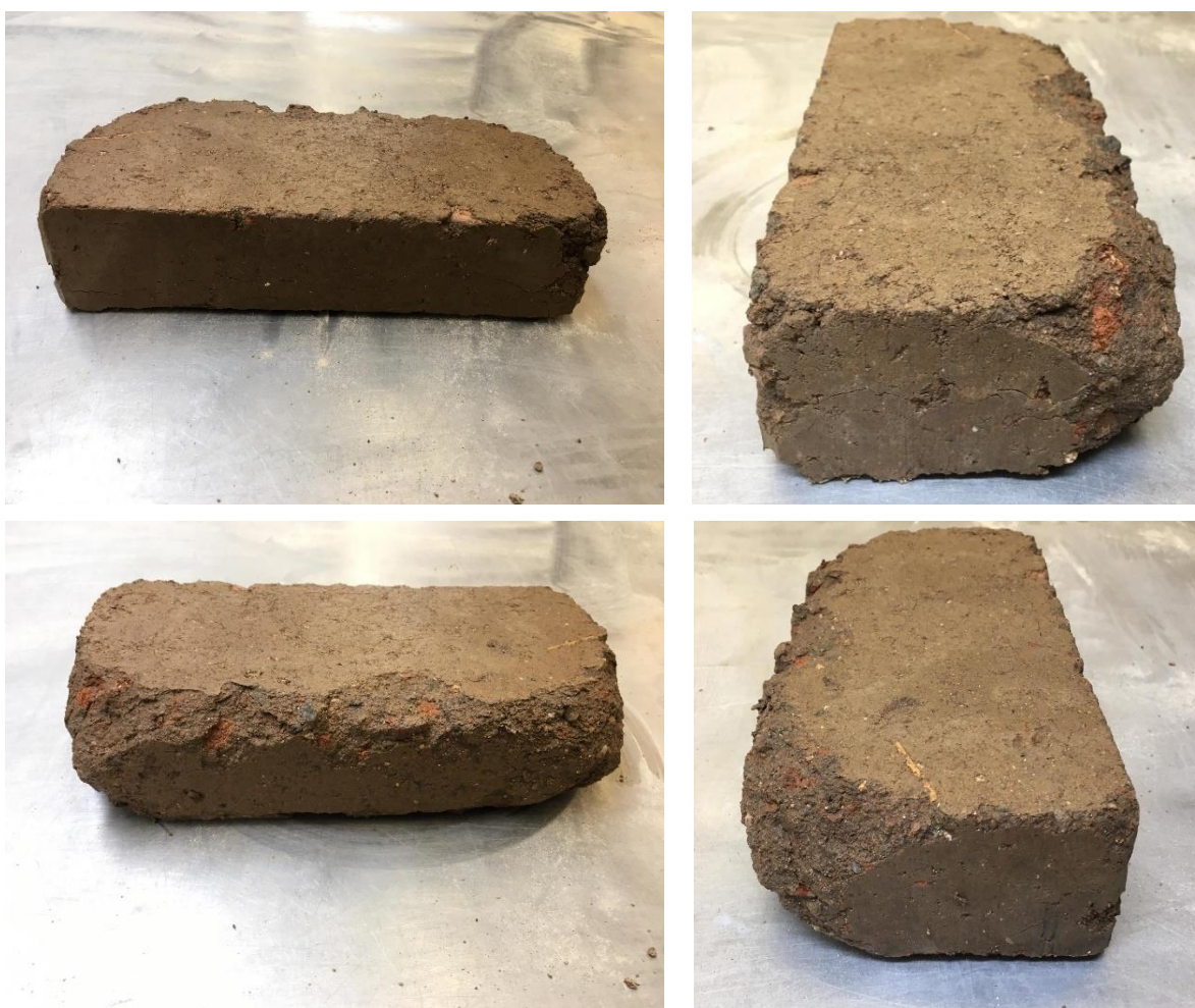
Figura 68: Absorção de água por imersão: provete 3
