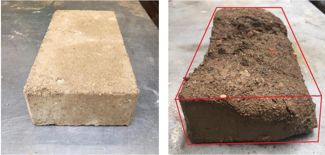
Figura 95: Ensaio de Erosão: Provete 6 face 2
