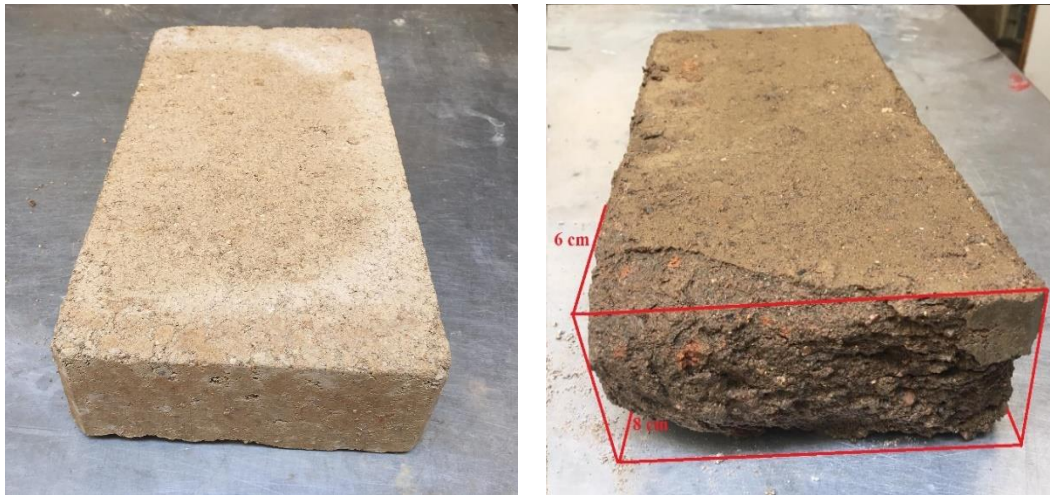
Figura 83: Ensaio de Erosão: Provete 3 face 2
