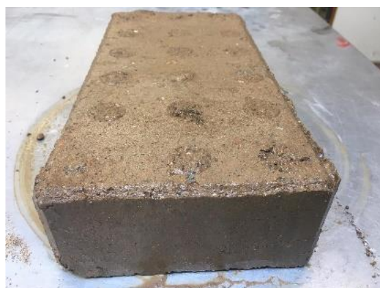
Figura 75: Ensaio de Erosão: Provede 1 face 2
