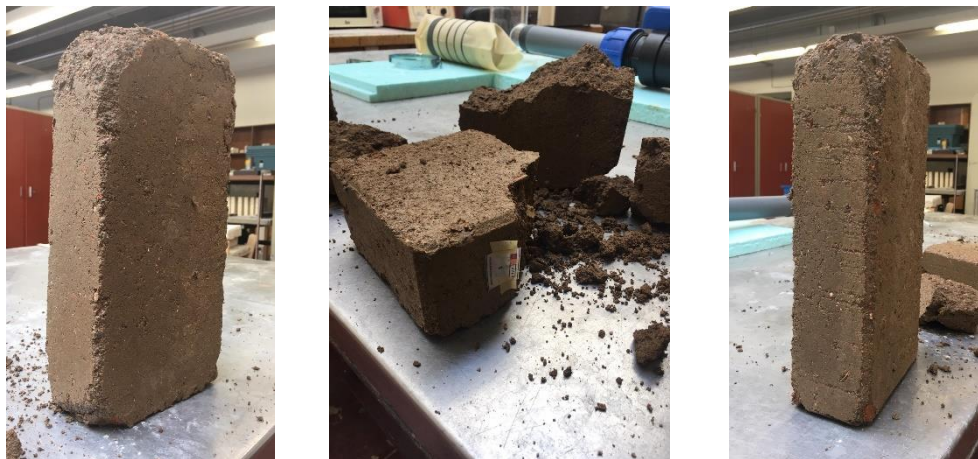
Figura 73: Estado dos blocos após o ensaio de absorção de água por capilaridade
