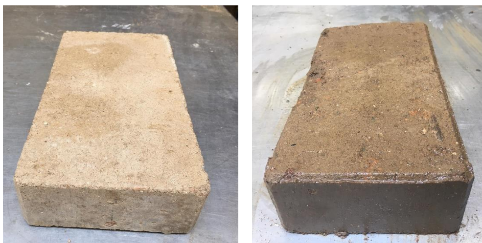
Figura 81: Ensaio de Erosão: Provete 2 face 4
