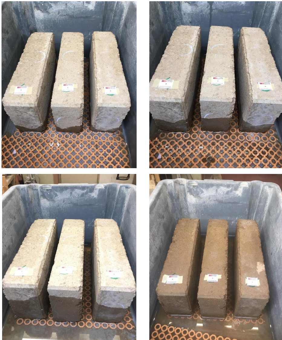
Figura 70: Ensaio de ascensão de água por capilaridade
