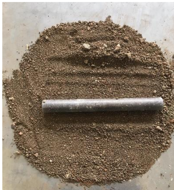
Figura 21: Destorroamento do solo
