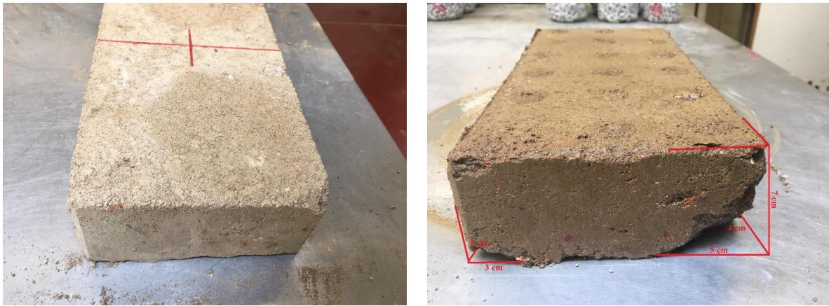
Figura 77: Ensaio de Erosão: Provete 1 face 4
