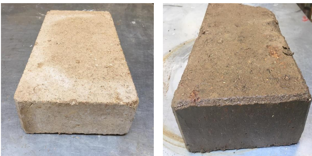
Figura 85: Ensaio de Erosão: Provete 3 face 4
