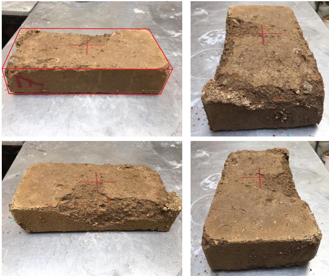
Figura 98: Ensaio de Erosão: Provetes 7
