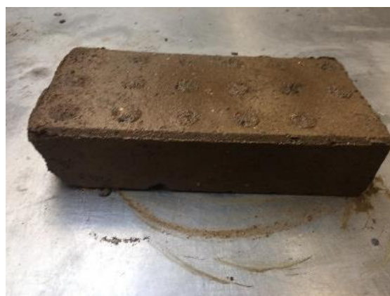
Figura 76: Ensaio de Erosão: Provede 1 face 3
