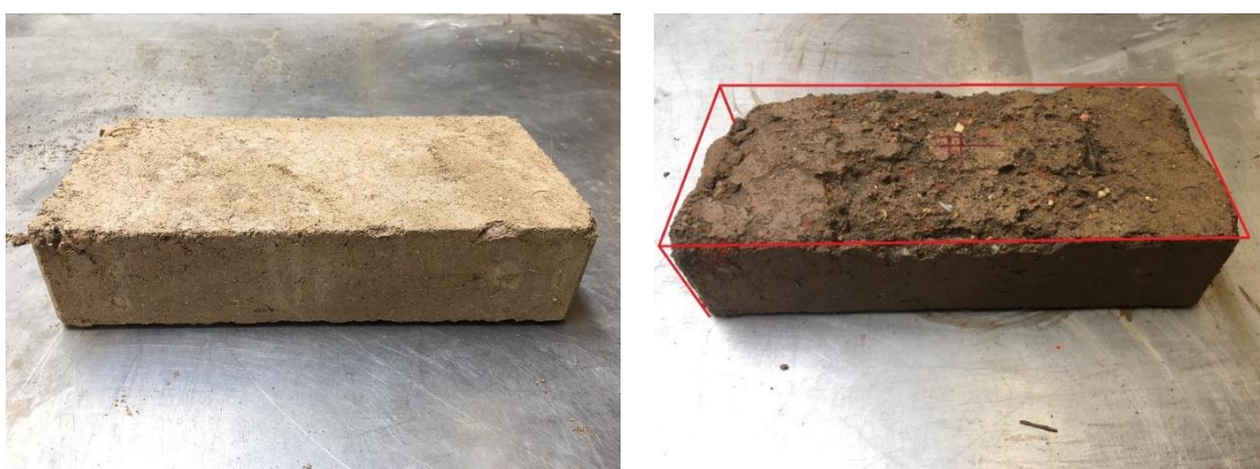
Figura 88: Ensaio de Erosão: Provete 4 face 3
