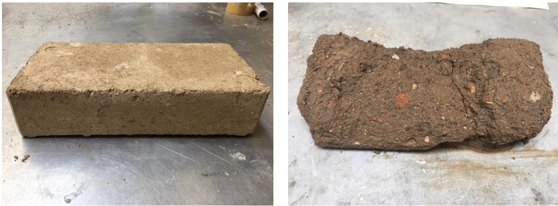
Figura 96: Ensaio de Erosão: Provete 6 face 3
