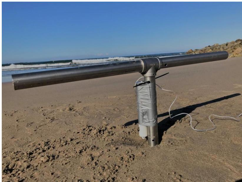
Figura 3-6 Estrutura de suporte com sonda instalados a sotamar do esporão sul da praia de Ofir.
