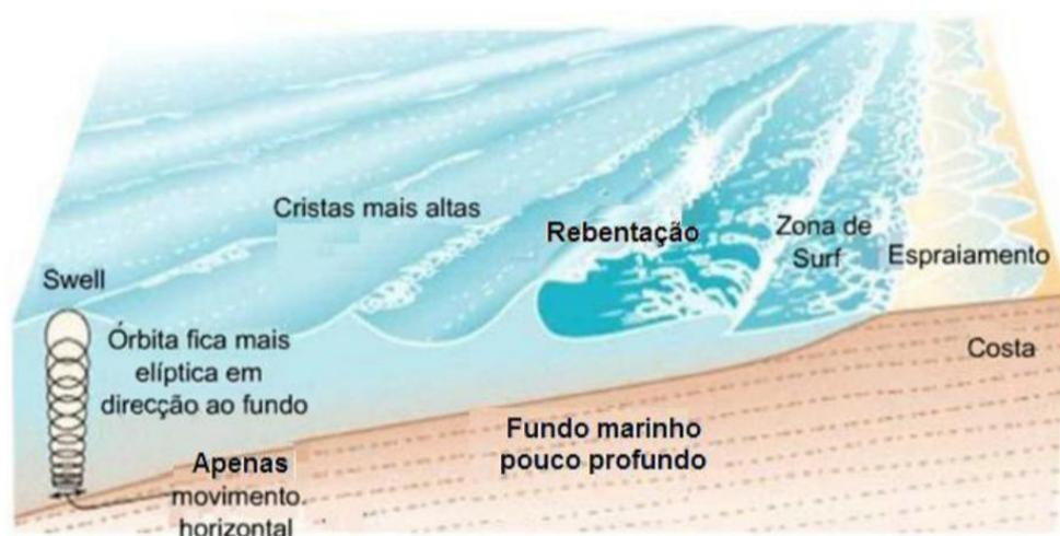
Figura 2-4 Empolamento e rebentação de onda (Silva, 2009).
