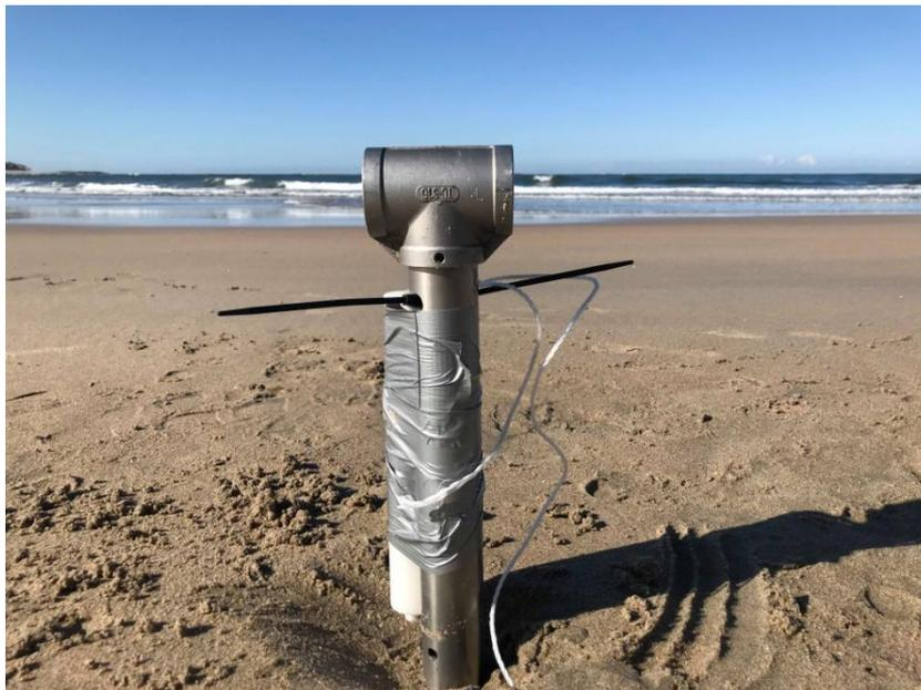
Figura 3-9 Sensor envolvido por abraçadeira de plástico e com fita isoladora.
