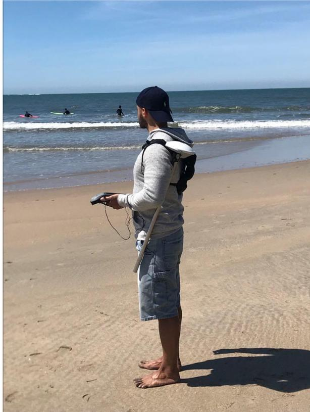
Figura 2-28 Utilização de bastão topográfico e antena externa.
