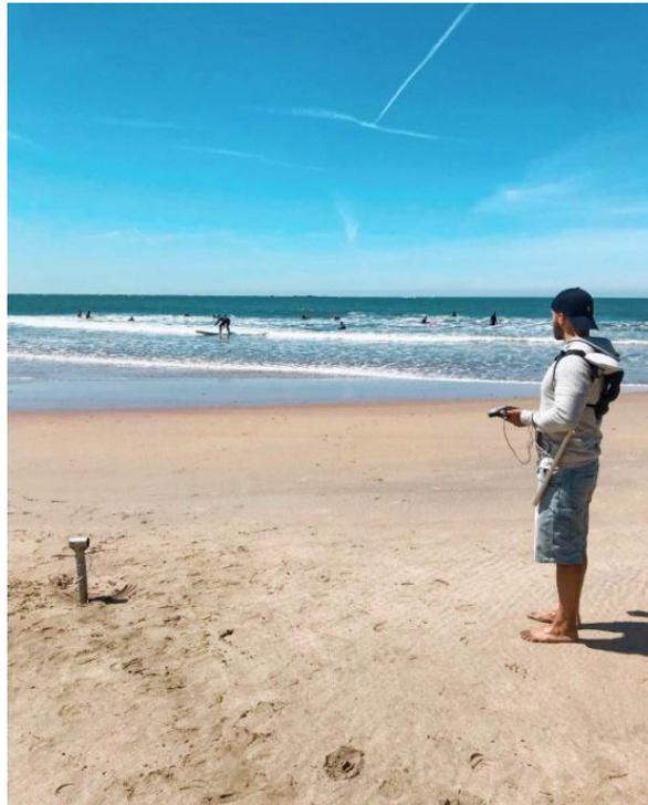
Figura 3-26 Levantamento topográfico na praia de Ofir, recorrendo ao equipamento DGPS, campanha do dia 1 de Maio de 2018.
