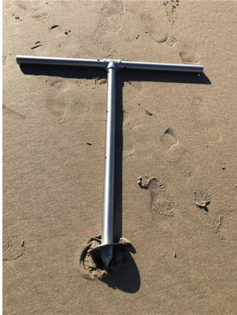
Figura 3-5 Estrutura de suporte à sonda TWR-2050.
