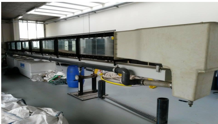
Figura 3.1 Vista longitudinal do canal hidráulico GUNT a montante do escoamento
