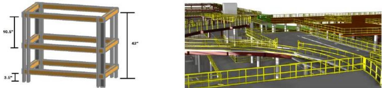
Figura 13 – Modelação do sistema de proteção contra quedas [26]
