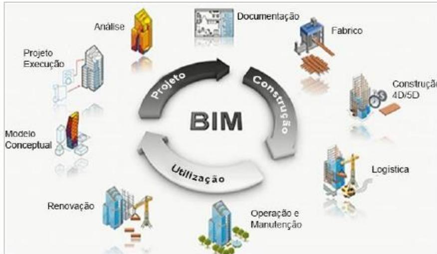
Figura 1 – Processo colaborativo do BIM [3]
