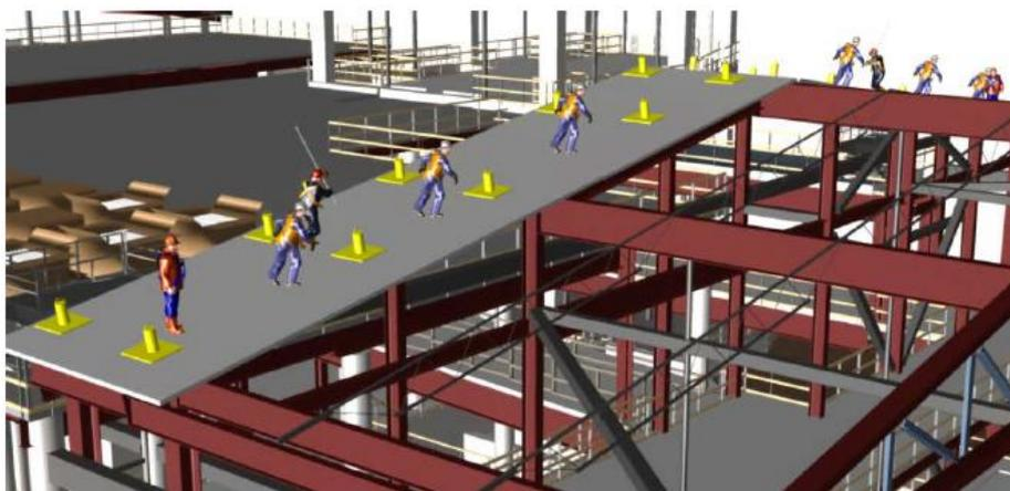
Figura 14 – Simulação da construção da cobertura usando o modelo BIM 4D [26]
