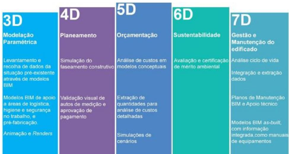
Figura 5 – Dimensões BIM [3]
