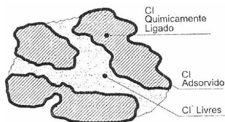
Figura 2-5 – Possível forma da ocorrência dos íões de cloreto nas estruturas de betão [32]
