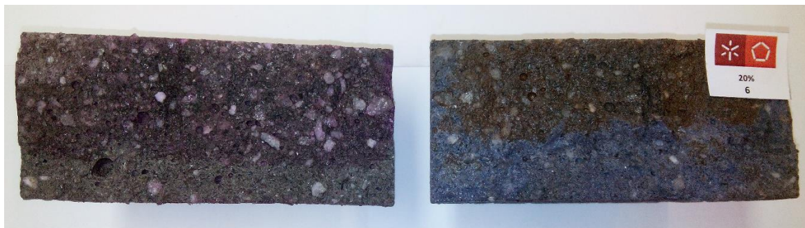
Figura 3-13 – Metades do provete submetido ao ensaio combinado pulverizadas com as soluções de modo à obtenção de resultados
