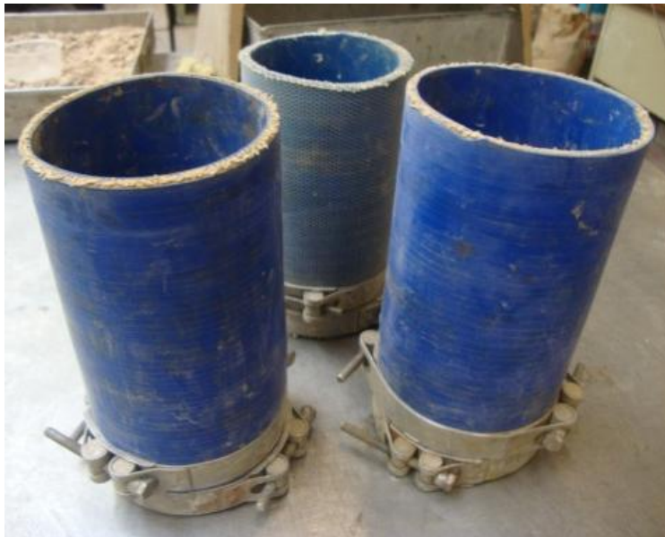
Figura 3-10 – Provetes introduzidos nas mangas de borracha apertados com as braçadeiras de aço inoxidável
