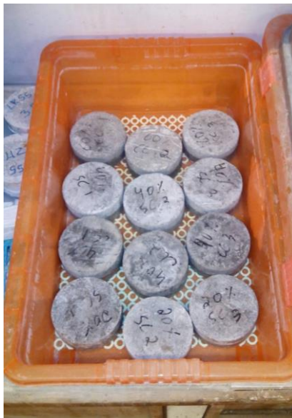
Figura 3-14 – Ensaio de capilaridade em curso
