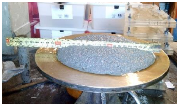
Figura 3-9 – Resultado do processo e medição do espalhamento
