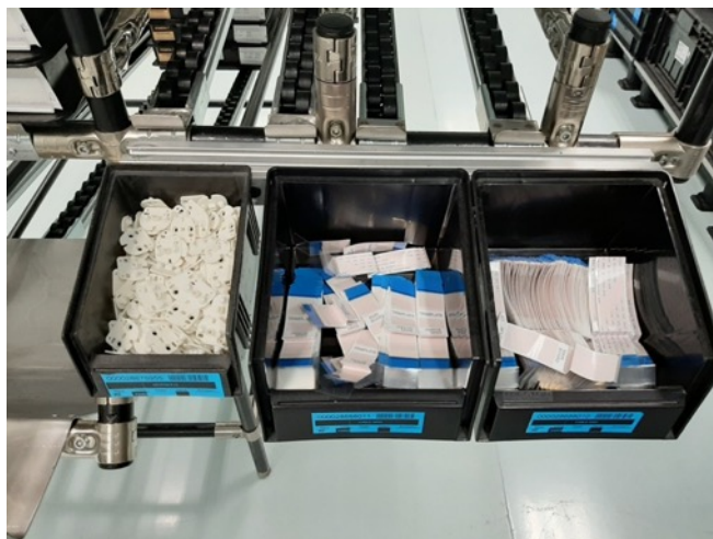
Figura 61 - Cabos com a melhoria e o keypad que passou a ser colocado no posto 1
