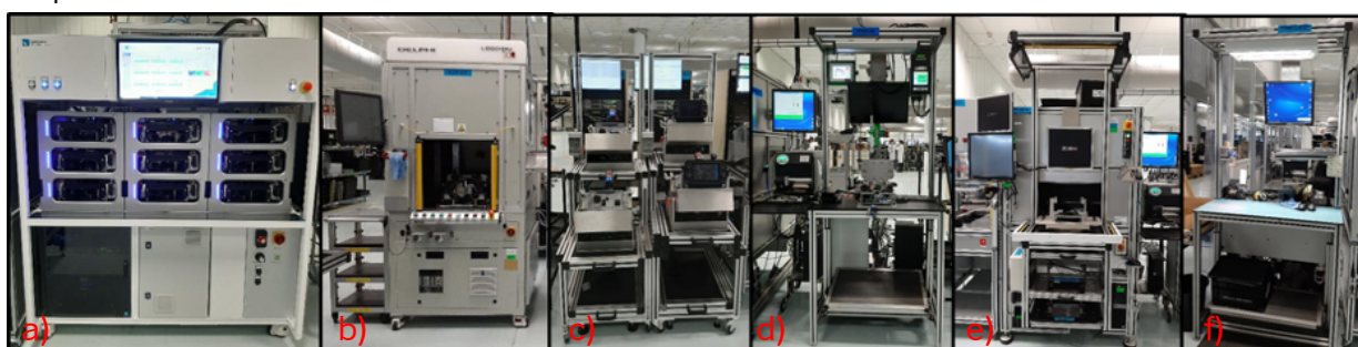
Figura 38 - Equipamentos e postos na zona de testes na linha de produção: a) Teste MOL; b) Teste Iluminação; c) Teste EOL; d) Posto Back Cover; e) Teste CMI; f) Embalagem
