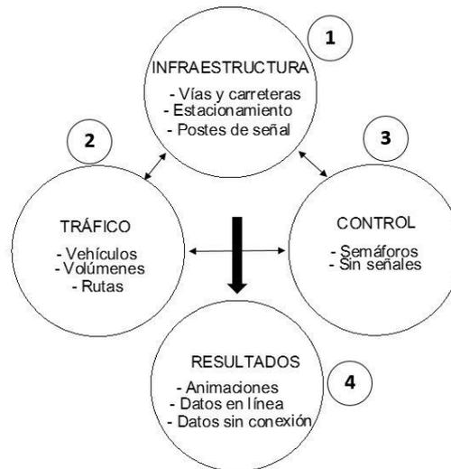
Figura 4 - Representación esquemática de los módulos de PTV VISSIM (Barceló, 2010)
