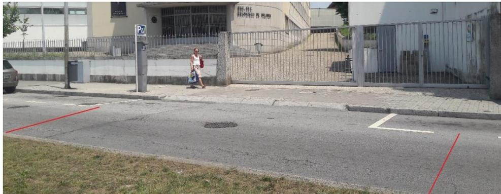
Figura 30 – Distancia de medición para velocidades de los vehículos
