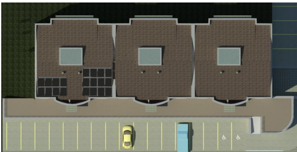
Figura 34 – Disposição dos coletores solares térmicos na cobertura (sudoeste)
