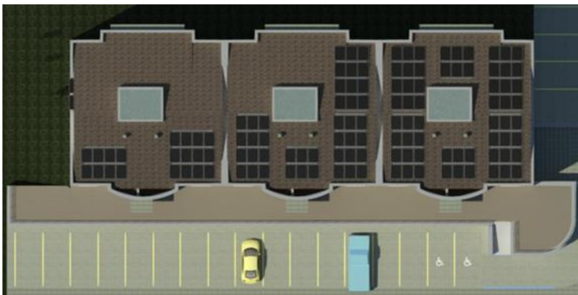
Figura 33 – Disposição dos coletores solares térmicos na cobertura (sudoeste) e dos painéis fotovoltaicos na cobertura (sudoeste e nordeste)
