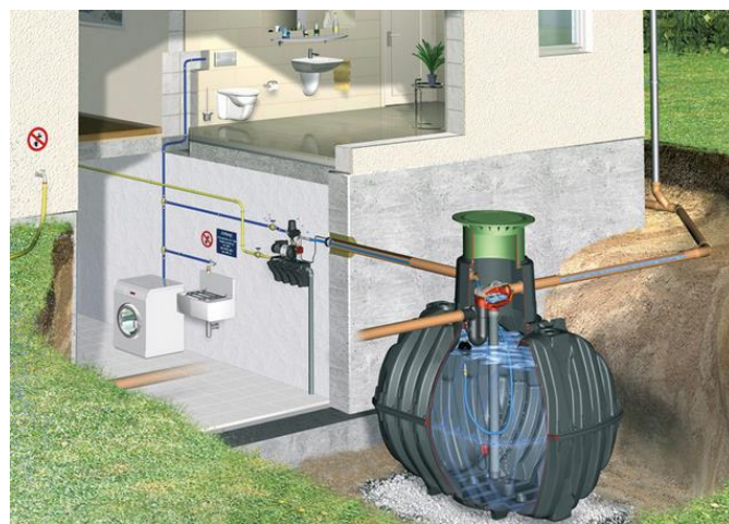
Figura 16 - Pack Carat Eco Plus de la empresa Otto Graf GmbH. Fuente: "Pack Carat Eco Plus GRAF para recuperar agua de lluvia", (2017).
