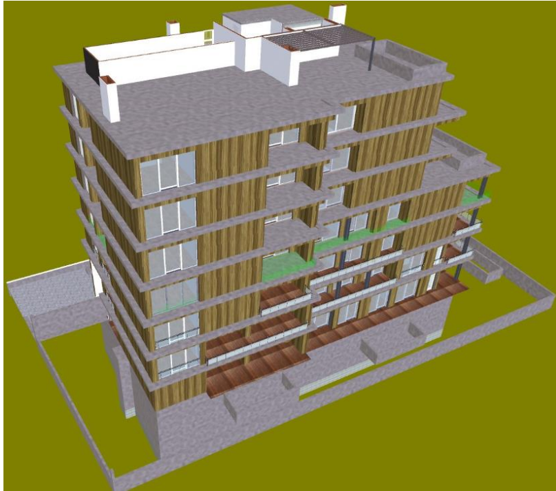
Figura 70 - Colocação dos pavimentos exteriores e gradeamento das varandas do piso 3 (Semana 108).
