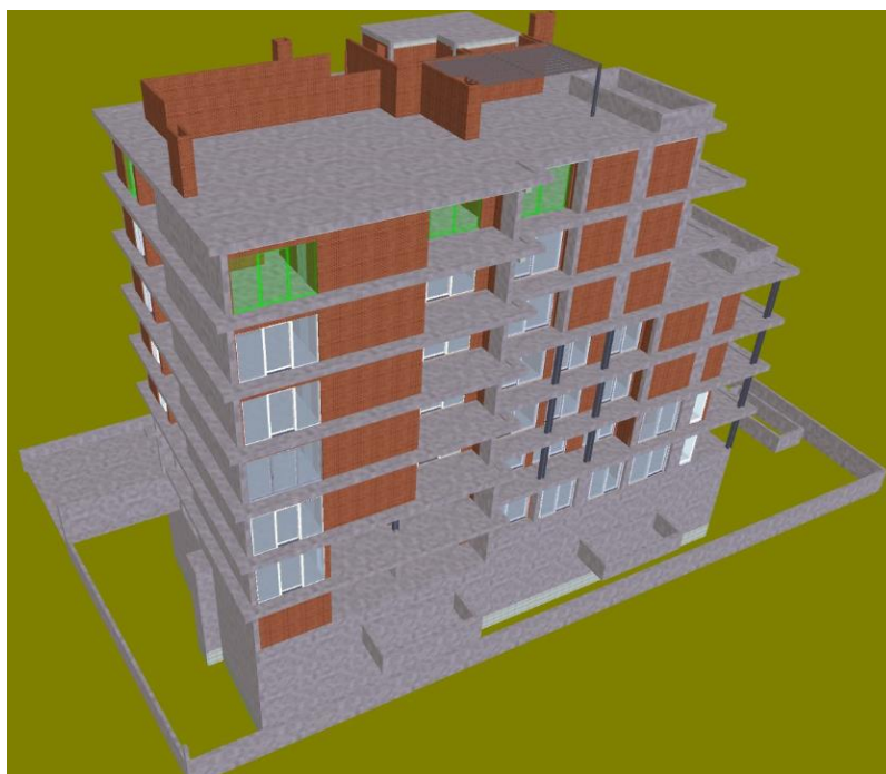
Figura 68 - Colocação das portas e envidraçados no piso 6 (Semana 71).
