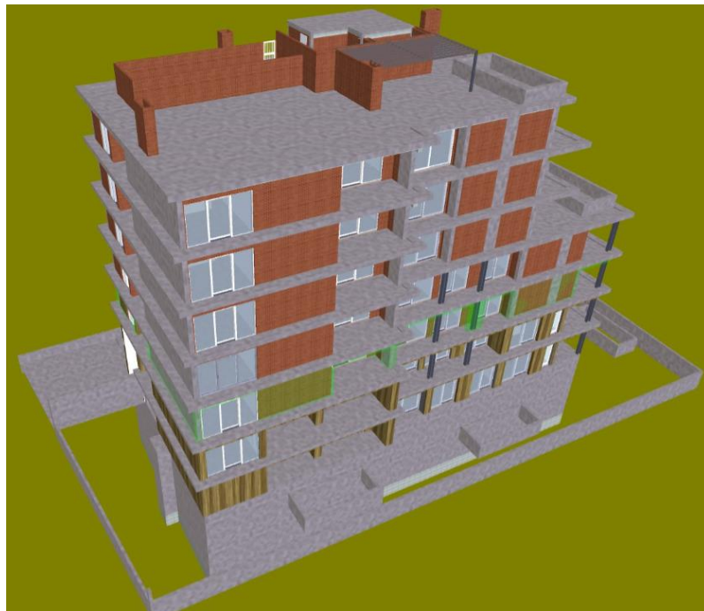
Figura 69 - Colocação dos revestimentos exteriores do piso 2 (Semana 101).
