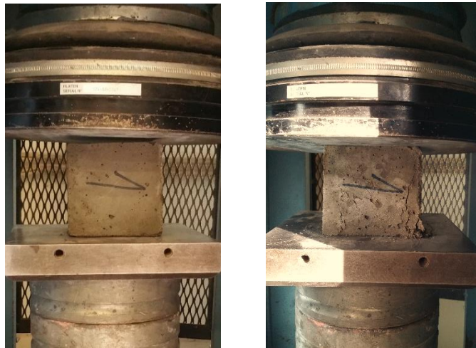
Figura 3-11 - Ensaio de resistência à compressão.
