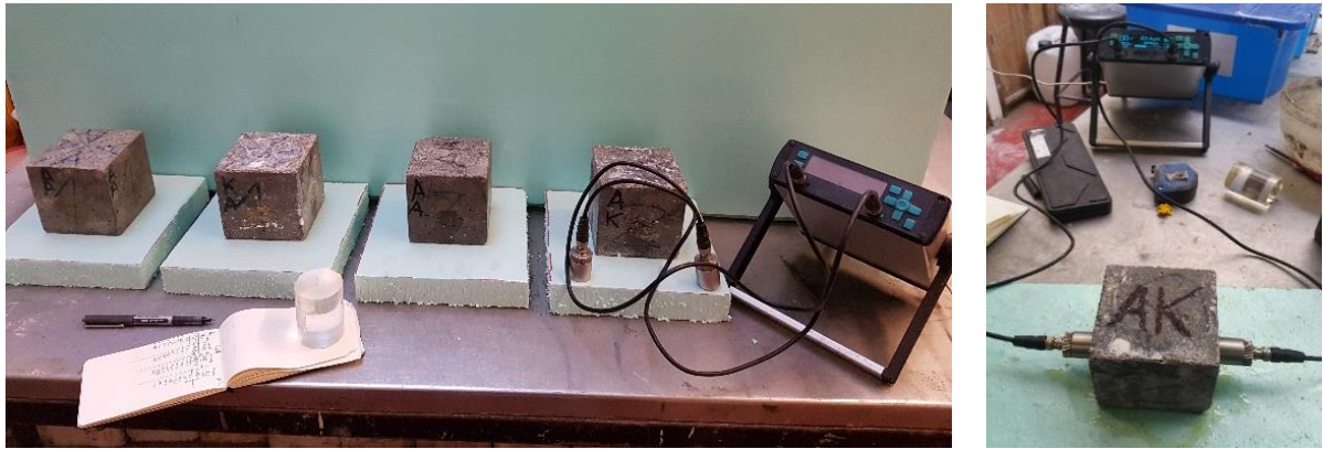
Figura 3-14 - Medição de Ultrassons.
