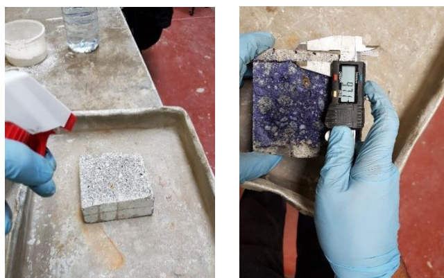
Figura 3-16 - Medição da profundidade de carbonatação.
