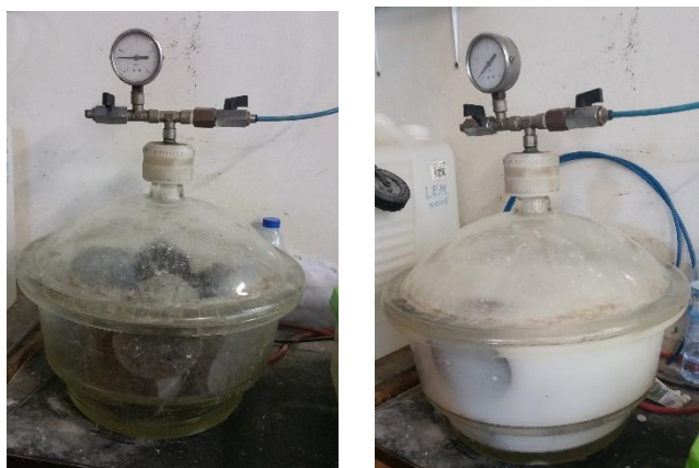
Figura 3-18 - Câmara de vácuo, antes e depois da dissolução de \text{Ca}(\text{OH})_2 .
