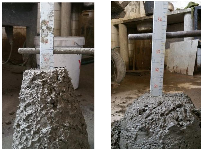
Figura 3-5 - Desmoldagem do provete e respetiva medição de abaixamento.
