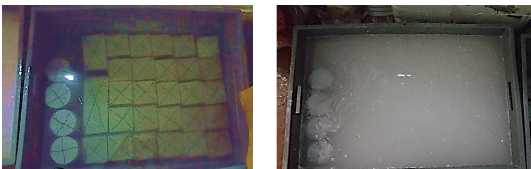
Figura 3-9 – Tanques com cura H (esq.) e cura CH (dir.).
