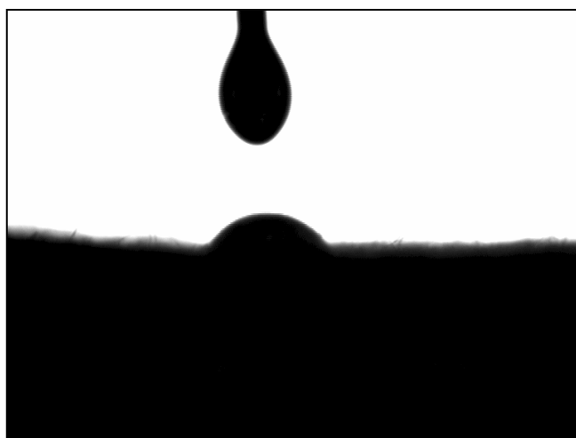
Figura 51 – Imagem do ângulo de contacto da solução de hidróxido de sódio e agente molhante com o algodão cru sem mercerizar
