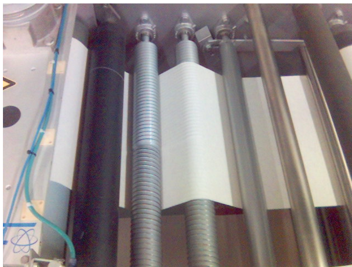
Figura 37 – Pormenor da máquina de descarga CORONA: rolos de tensionamento da amostra
