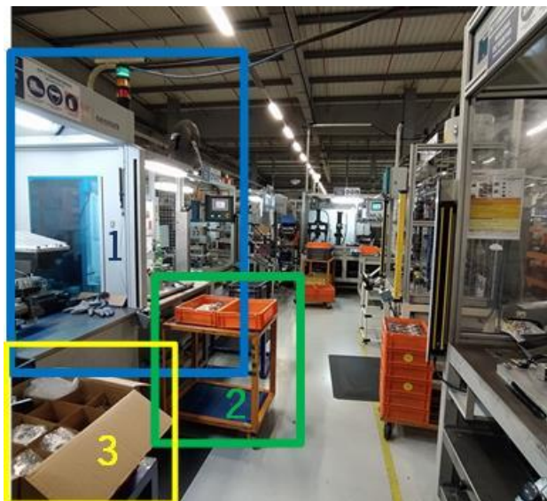
Figura 23 - Vista da linha com identificação de máquinas: 1) Neo 2) produto final 3) matéria-prima
