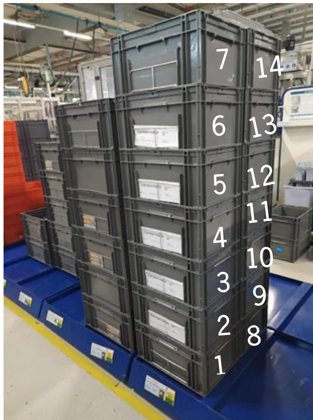
Figura 42 - Supermercado de saída (chão) com excesso de caixas (14 caixas)
