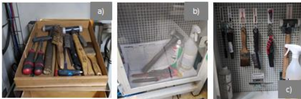
Figura 63 - Arrumação do material junto à máquina: Antes- a) dentro da máquina; b) armário; Depois - c) proposta implementada
