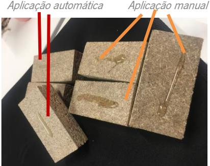
Figura 68 - Comparação entre a aplicação de cola automática e manual
