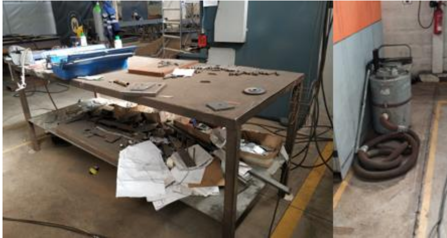
Figura 30: Falha na aplicação de 5S nas áreas gerais do chão de fábrica
