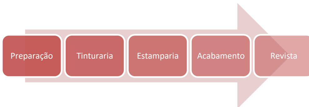
Figura 33: Etapas do Processo de Acabamento do substrato têxtil
