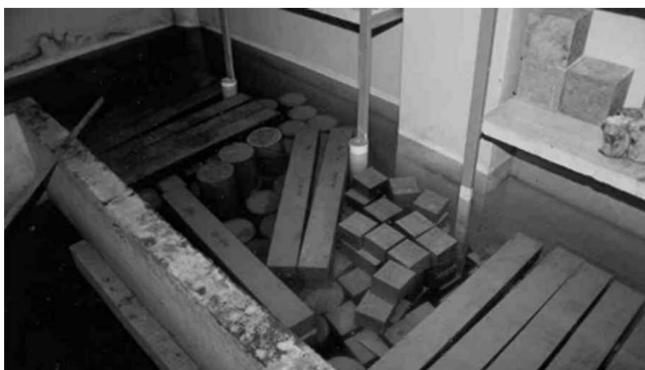
Figura 6.11 – Conservação dos provetes imersos em água na câmara húmida
