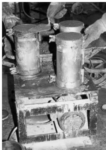
Figura 6.10 – Moldagem de provetes cilíndricos de 150 mm de diâmetro e 300 mm de altura
