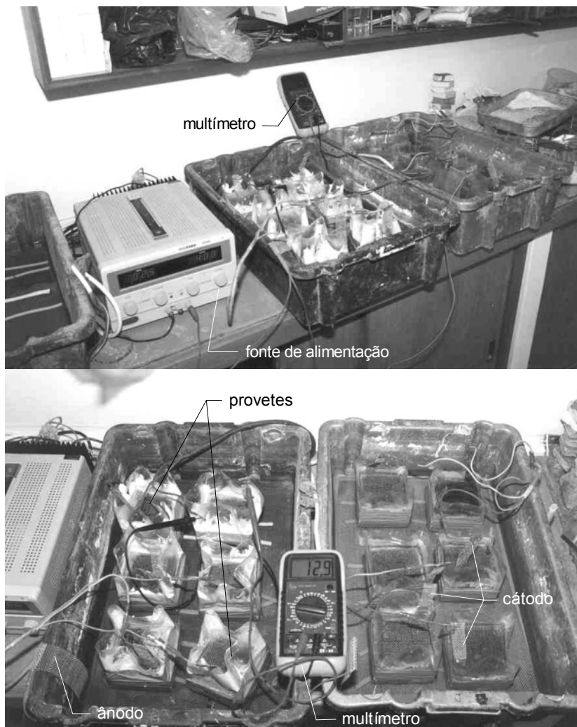
Figura 6.30 – Configuração geral de um ensaio de penetração de cloretos em curso
