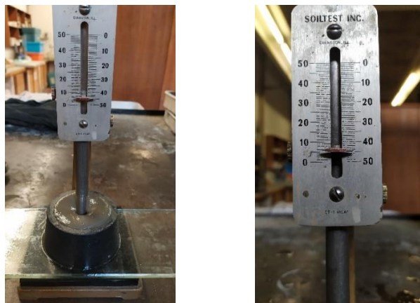
Figura 3.28 – Leitura da penetração de uma pasta de cimento para a obtenção da consistência normal
