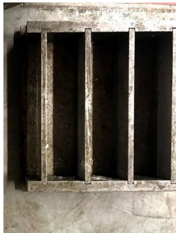
Figura 3.29 – Moldes metálicos para fabrico de provetes prismáticos
