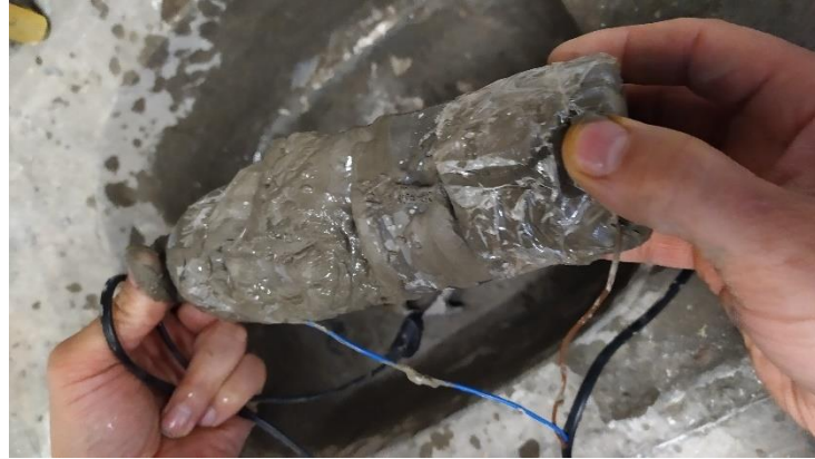
Figura 3.10 – Garrafa de plástico de 75 ml utilizada como provete de ensaio
