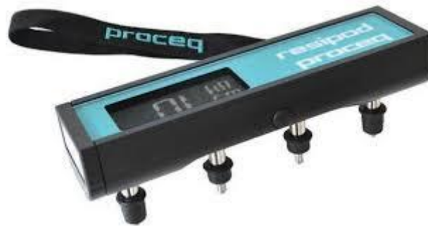
Figura 2.7 – equipamento de medição - Sonda Wenner
