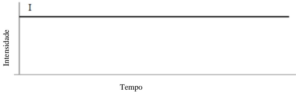
Figura 2.6 - Forma da onda de uma corrente contínua (adaptado de [33])
