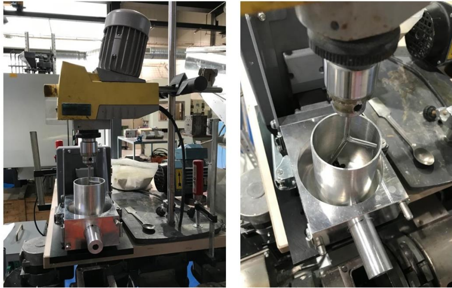
Figura 21. Alimentador de argila utilizado no processo.
