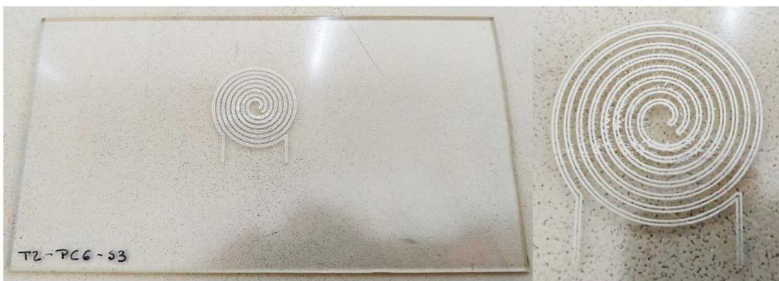
*Figura 77: Imagens do resultado da impressão por serigrafia na placa T2-PC6-S3*
