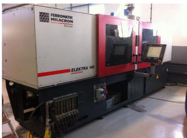
*Figura 28: Imagem da máquina de moldação por injeção utilizada, a Ferromatik Elektra Evolution 110-300*
