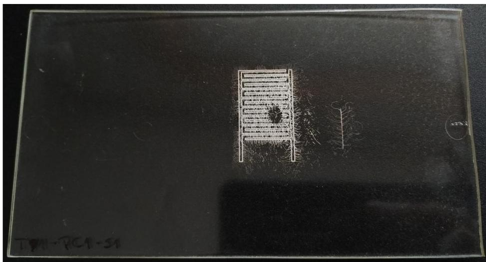
Figura 53: Imagem do resultado da impressão por serigrafia da placa T1-PC1-S1
