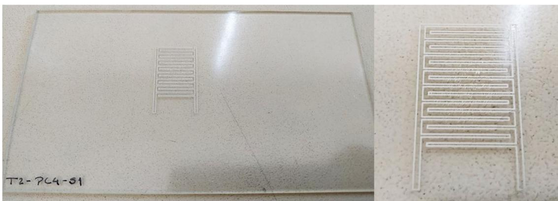
Figura 75: Imagens do resultado da impressão por serigrafia na placa T2-PC4-S1
