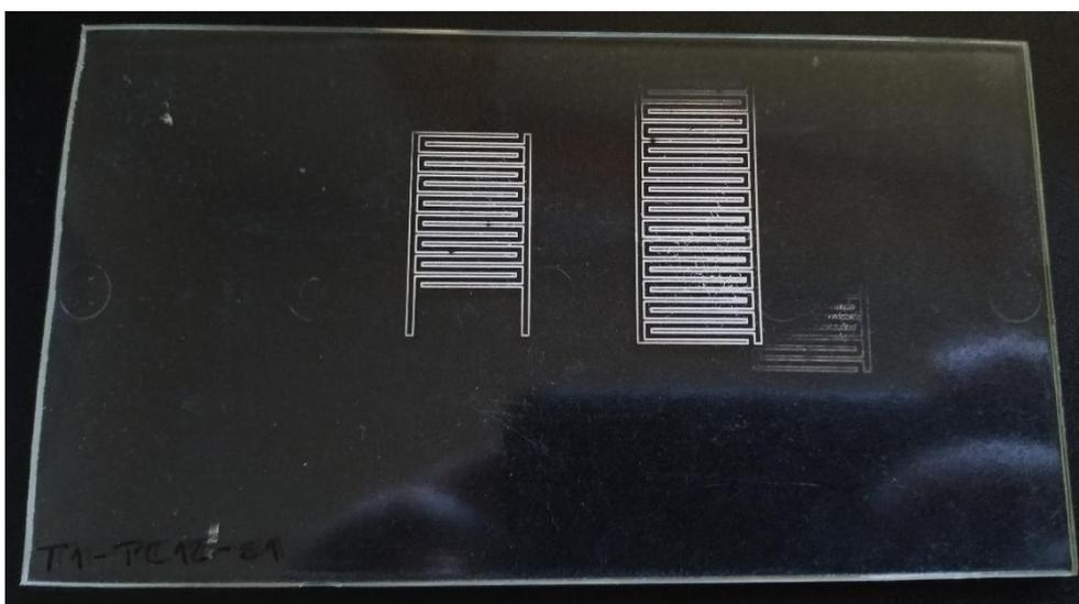
*Figura 67: Imagem do resultado da impressão por serigrafia na placa T1-PC12-S1*
