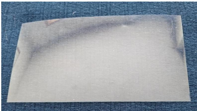
Figura 10: Exemplo de um filme de PEN cortado com as dimensões de 150mmX80mm
