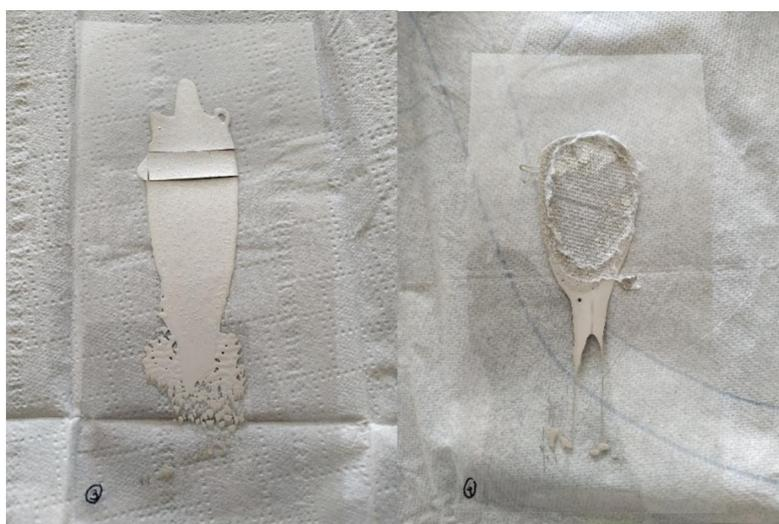
*Figura 13: Imagens dos primeiros resultados dos filmes com a tinta de prata HPS FG57B. A imagem da esquerda representa o Filme 3 e a da direita o Filme 4*
