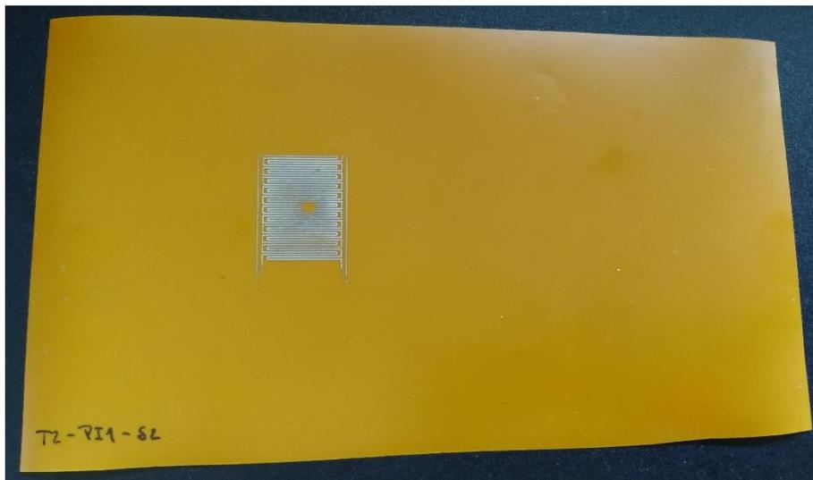
*Figura 68: Imagem do resultado da impressão por serigrafia no filme T2-PI1-S2*
