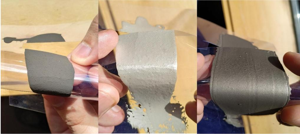
*Figura 18: Imagens dos três resultados obtidos no teste de dobra para os três filmes de menor espessura de tinta impressa. Na imagem da esquerda encontra-se a imagem do Filme 1, no centro da imagem do Filme 3 e na direita a imagem do Filme 5*
