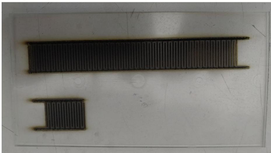
*Figura 42: Imagem representativa do resultado do segundo teste de gravura numa placa de PC*
