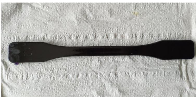
*Figura 25: Imagem de um provete de PC que foi usado para o teste de adesão*
