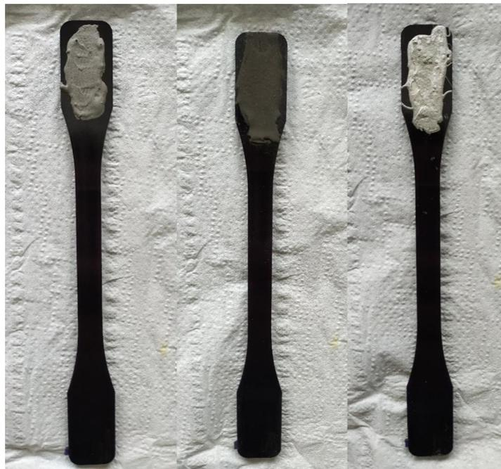
*Figura 26: Imagens dos resultados obtidos para os testes de adesão com os provetes de PC. A imagem da esquerda representa o resultado para a tinta de níquel HPN-DEV-79-89-66, na imagem do centro para a tinta HPN-DEV-79-89-84 e na da direita para a tinta HPS FG57B*
