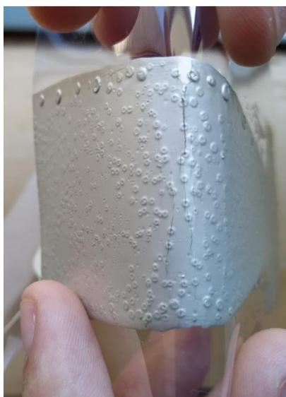
*Figura 22: Imagem do resultado obtido no teste de dobra para o filme impresso com a tinta de prata HPS FG57B*
