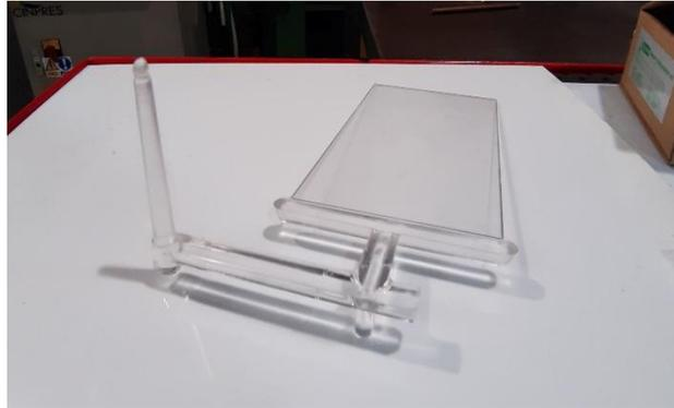
*Figura 29: Imagem de uma placa injetada após a extração da peça da máquina*
