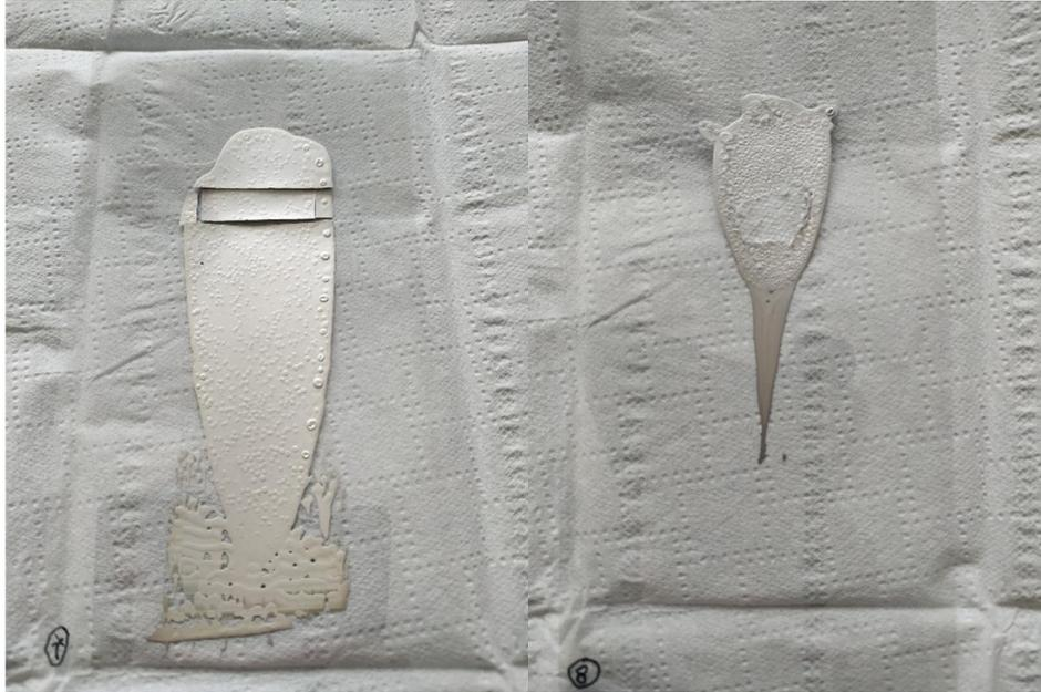
*Figura 19: Imagens dos segundos resultados dos filmes com a tinta de prata HPS FG57B. A imagem da esquerda representa o Filme 7 e a da direita o Filme 8*
