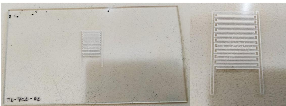
Figura 73: Imagens do resultado da impressão por serigrafia na placa T2-PC2-S2
