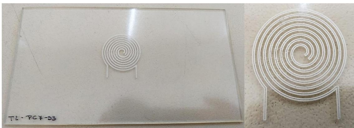
*Figura 78: Imagens do resultado da impressão por serigrafia na placa T2-PC7-S3*
