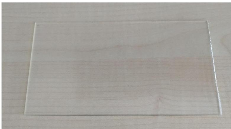
*Figura 30: Imagem de uma placa retangular sem o jito*
