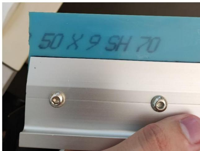
Figura 2: Imagem do *squeegee* utilizado durante o processo de impressão
