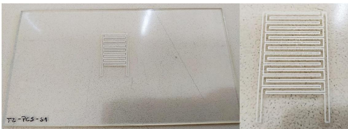
Figura 76: Imagens do resultado da impressão por serigrafia na placa T2-PC5-S1
