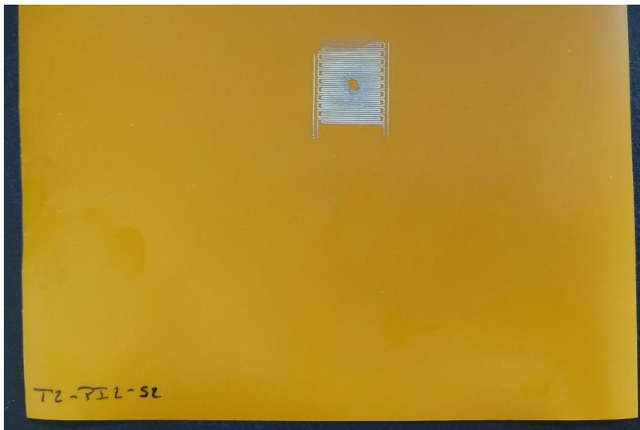
*Figura 69: Imagem do resultado da impressão por serigrafia no filme T2-PI2-S2*
