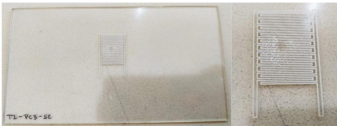
Figura 74: Imagens do resultado da impressão por serigrafia na placa T2-PC3-S2
