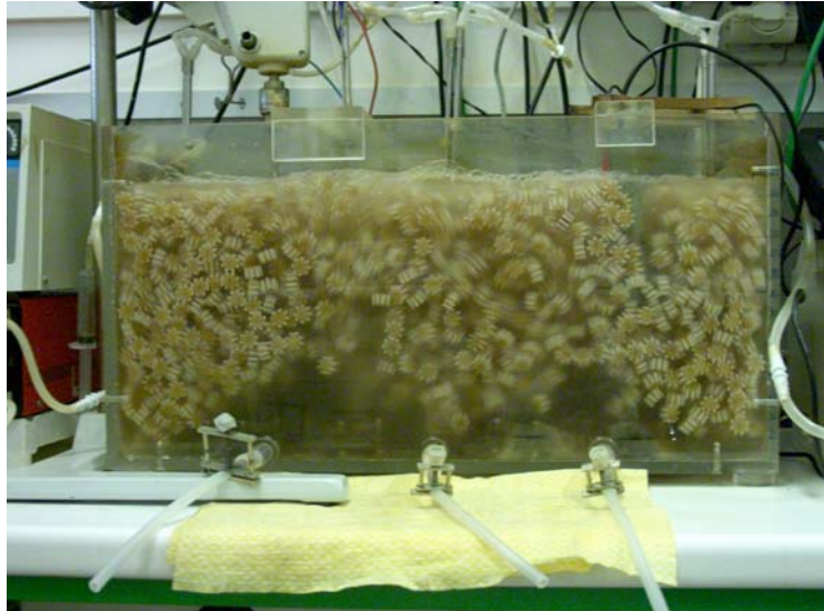
Figura 2.2 – Os dispersores de ar comprimido permitem uma perfeita circulação das peças de enchimento.
