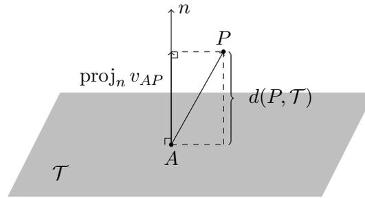
Figura 2.9: Distância de um ponto a um plano usando a projeção ortogonal.
