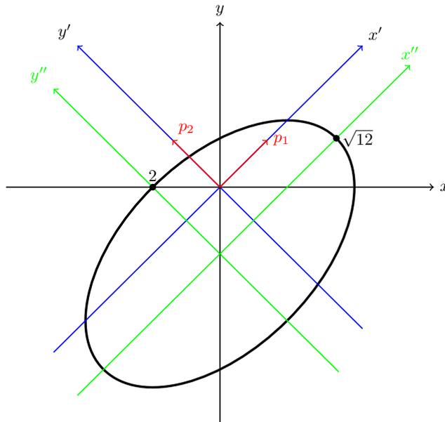
Figura 3.13: Esboço da cónica  $2x^2 - 2xy + 2y^2 - 2\sqrt{2}x + 4\sqrt{2}y = 8$ .
