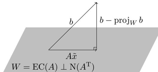
Figura 1.12: Vetor  $b - \text{proj}_W b$  ortogonal a  $EC(A)$ .
