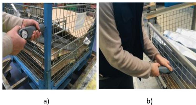
Figura 68: Estudo com o dinamómetro nas medições de forças do empurrar e puxar: a) Estudo do empurrar com o dinamómetro; b) Estudo do puxar com o dinamómetro
