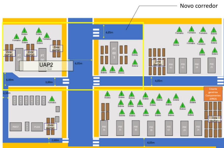
Figura 81: Layout das linhas de estampagem da Nave 1, mostrando a UAP2 com a prensa PT003 e a abertura do corredor. No entanto, devido a abertura de um corredor, cujo abertura diz respeito a largura da passagem de um empilhador ou comboio com a maior embalagem que será utilizada na nova prensa, não permite uma grande fluidez, como se pode observar na Figura 82.
