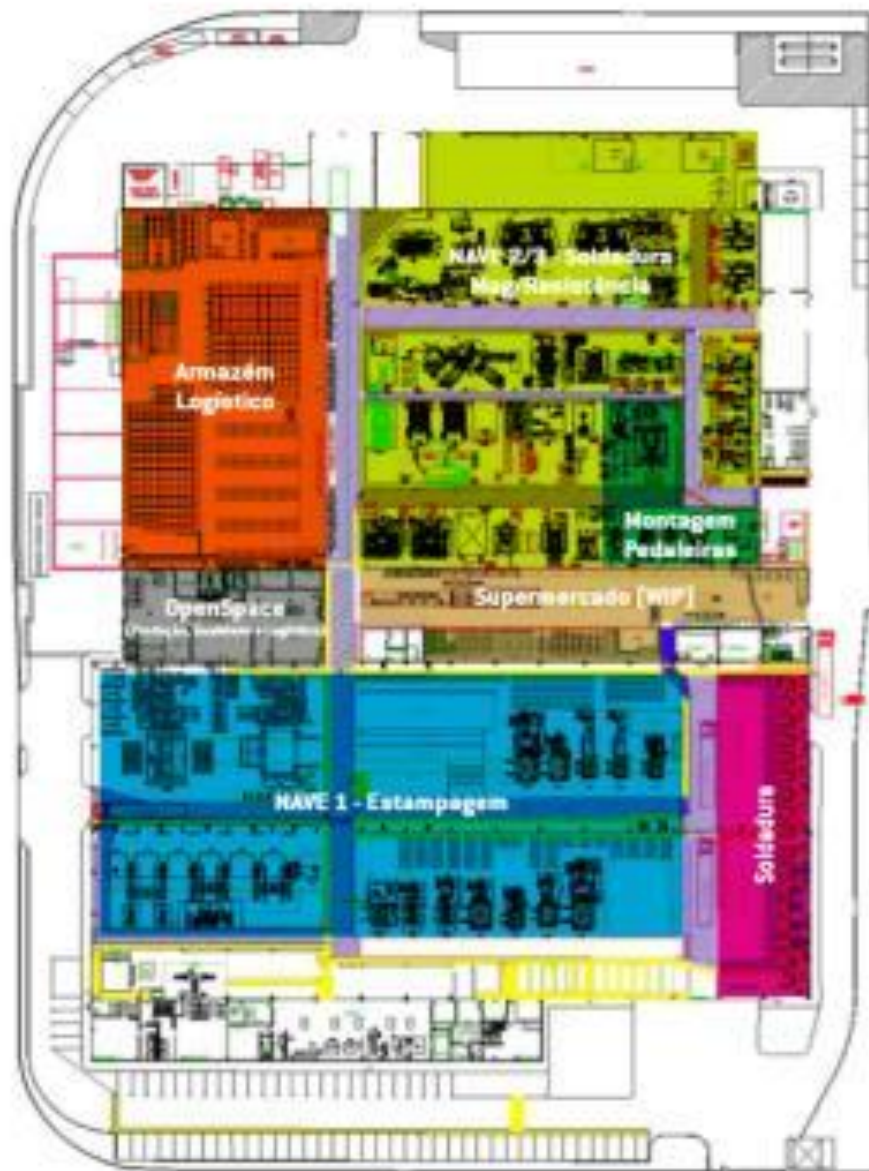
Figura 25: Layout por seções de processos produtivos e armazenagem (Gestamp, 2018)
