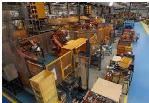
Figura 31: Linha de soldadura MAG (Gestamp, 2018)
