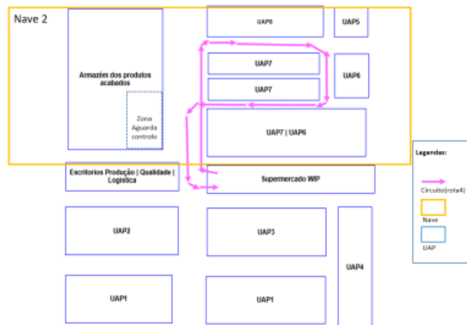
Figura 158: Rota efetuado pelo comboio logístico da Rota 3
