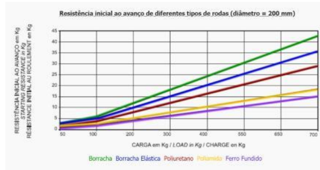
Figura 101: Estudo sobre a resistência inicial ao avanço de diferentes tipos de rodas (Mecanarte a), 2020)
