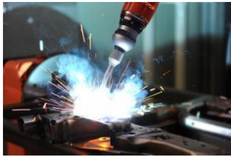
Figura 32: Máquina da soldadura híbrida em ação (Gestamp, 2018)
