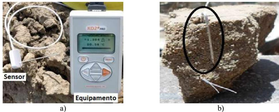
**Figura 3** - a) Equipamento K2-PRO; b) Detalhe do gabarito no interior da amostra do solo.
