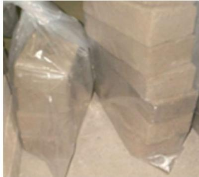
**Figura 2** - Blocos em processo de cura.
