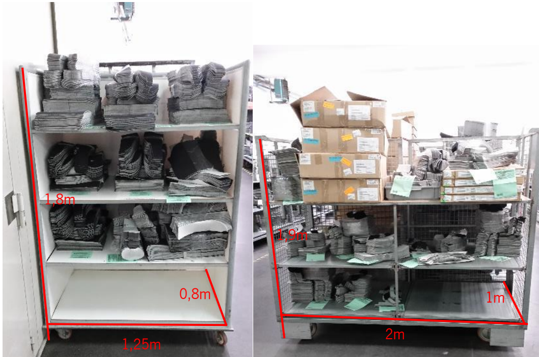
Figura 38 - Racks da secção de corte
