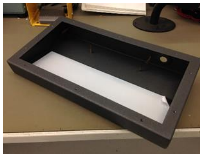
Figura 57 - Remoção de película do policarbonato
