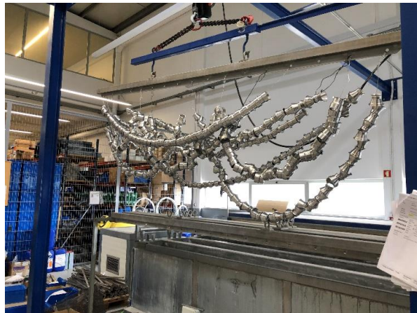
Figura 113 – Peças a serem carregadas na tina de desengordurar
