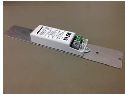
Figura 53 – Conjunto chapa suporte + driver Tempo de preparação médio: 0:01:15
