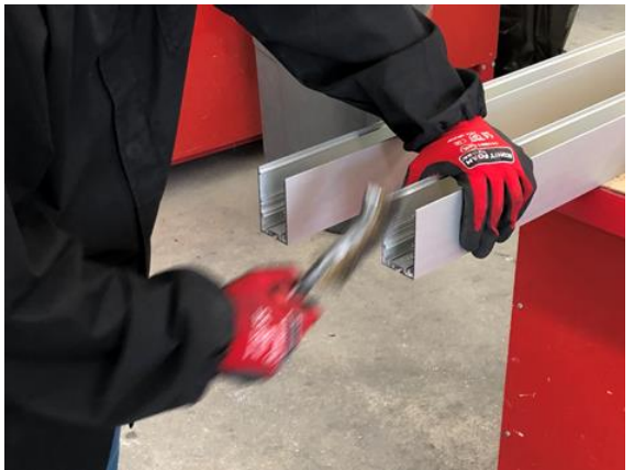
Figura 175 - Passagem de escova de aço nos topos
