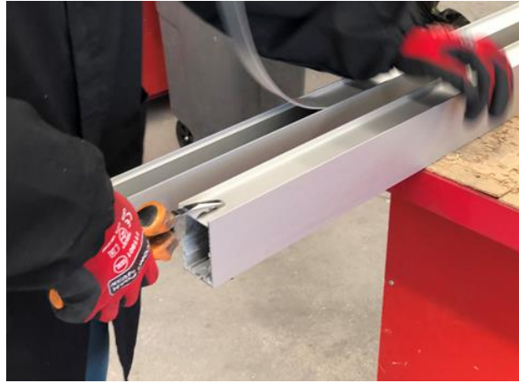
Figura 172 - Remoção do reforço do perfil
