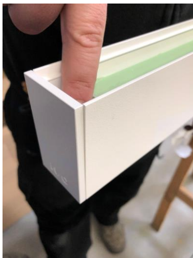
Figura 210 – Topo mal encaixado
