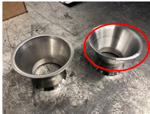
Figura 99 – Refletor antes e depois da operação de torno
