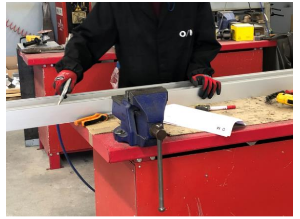
Figura 176 - Sopro de ar para remover limalha
