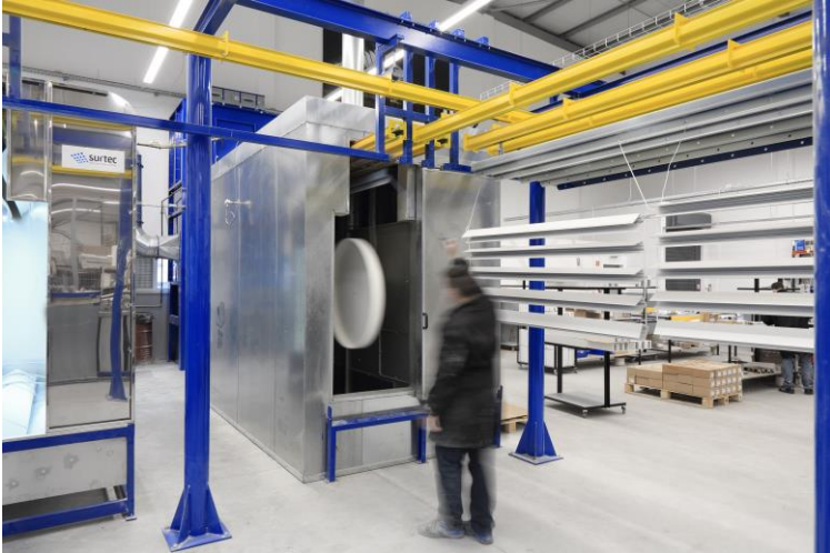
Figura 30 - Colocação da peça na estufa de cura
