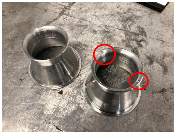
Figura 102 – Refletor com e sem furação
