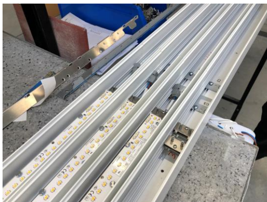
Figura 191 – Conjunto de luminárias com régua
