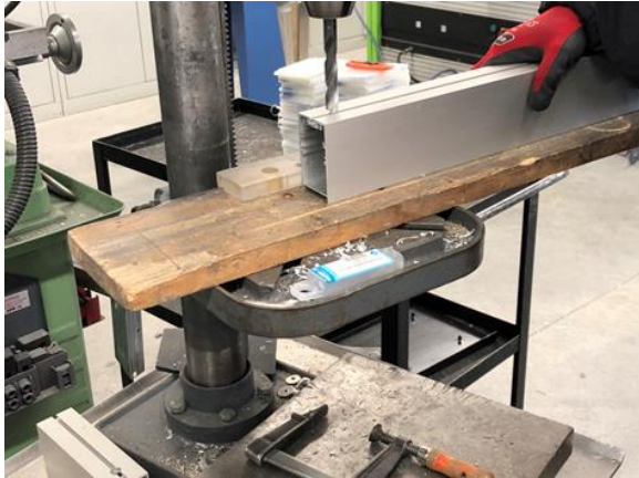
Figura 171 - Furação no engenho para furo de passagem de corrente
