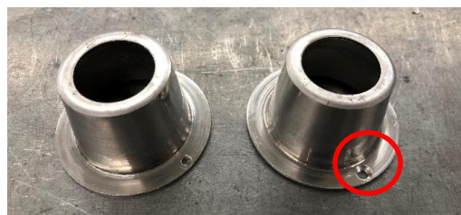
Figura 107 – Peça com quebra de aresta no furo
