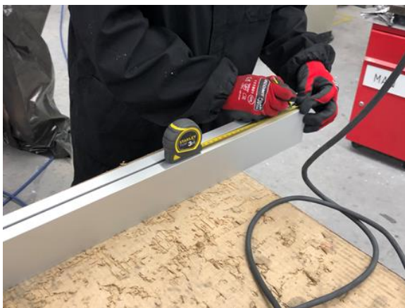
Figura 169 - Verificação da dimensão e marcação da furação
