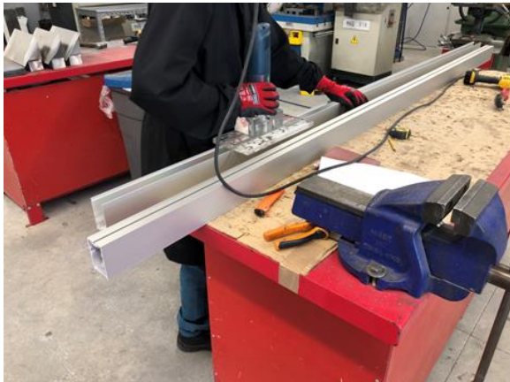
Figura 173 - Remoção da rebarba
