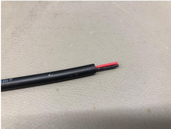
Figura 142 – Cabo descarnado (ponta driver)
