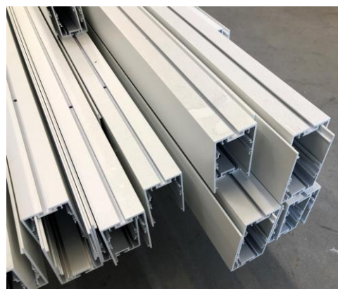
Figura 208 – Pó acumulado nos perfis depois pintados
