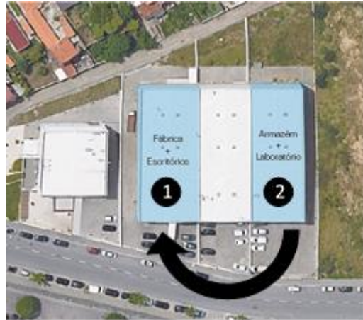
Figura 70 - Fluxo de material entre edifícios
