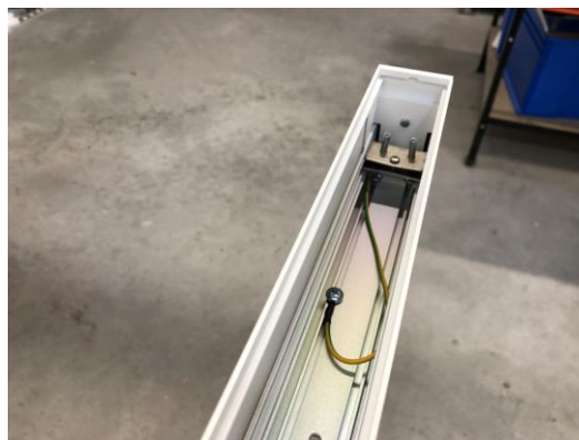
Figura 189 – Cabo terra e suportes de régua
