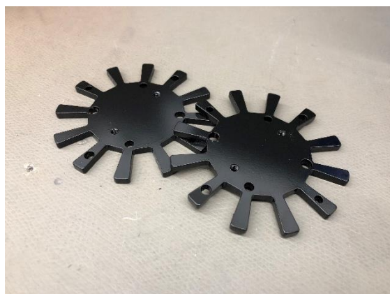
Figura 129 – Dissipadores com tratamento cataforese
