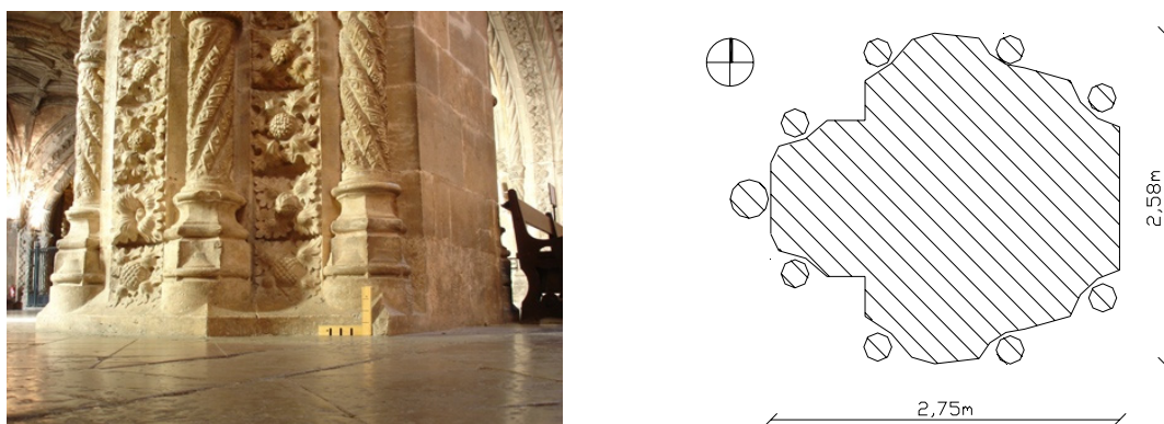
Figura 4.15 – Secção transversal do pilar levantado (P1) entre o Coro Alto e o pavimento da Igreja.
